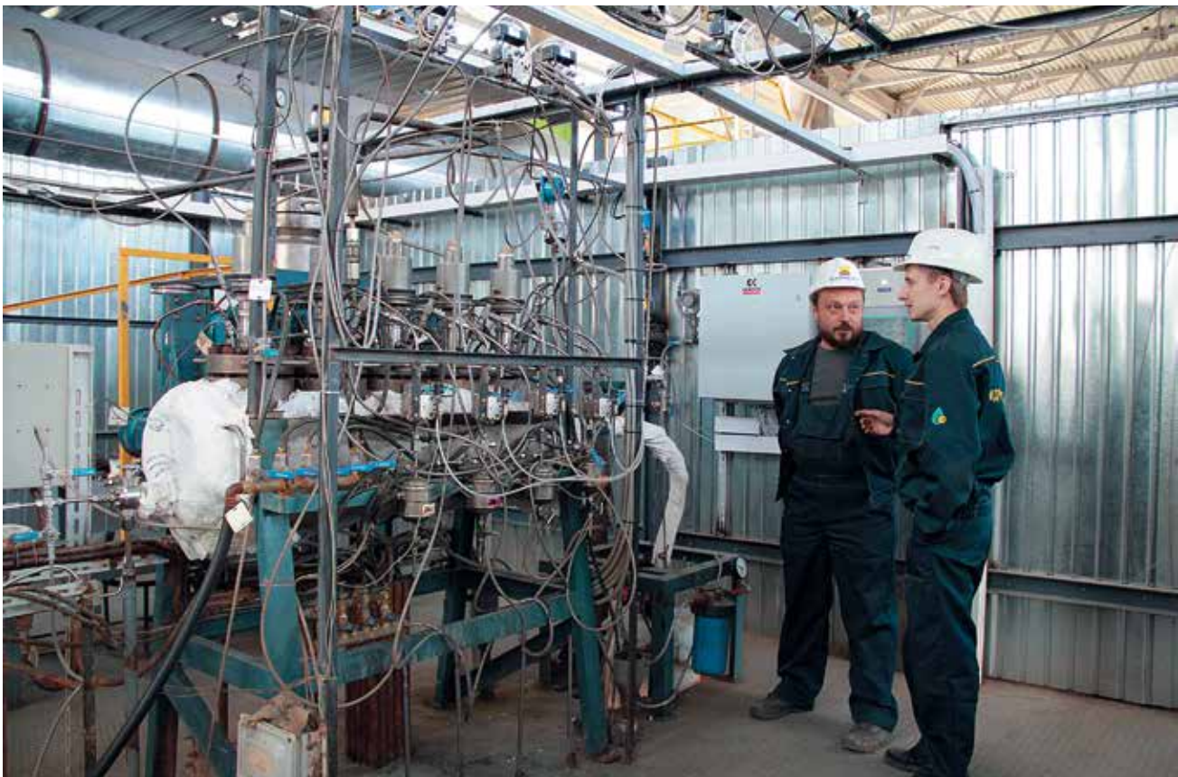
Полупромышленные исследования на пилотном автоклавке на ОПЗ в Благовещенске
