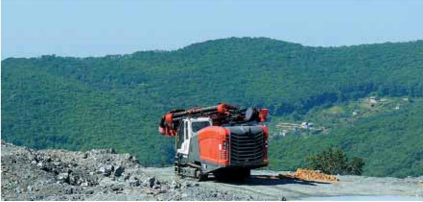
328 кВт. Производительность такой буровой установки достигает 1,85 Мт в год.
