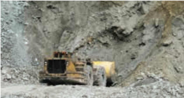
Рис. 6. Отгрузка руды с помощью ПДМ типа «Торо-400», оборудованной системой дистанционного радиоуправления типа «Торотел»
