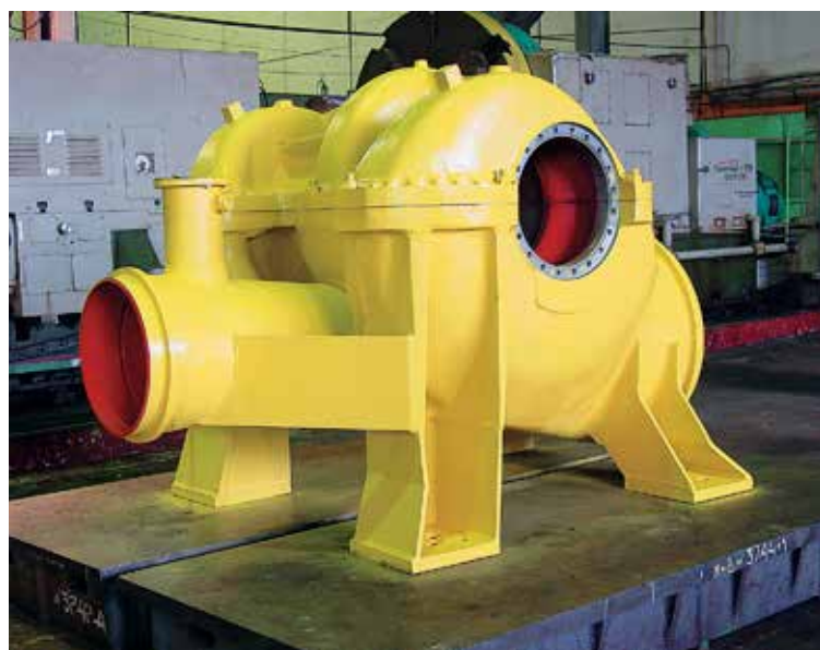
Корпус нефтяного насоса
