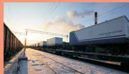
Погрузка мобильных зданий на железнодорожном транспорте
