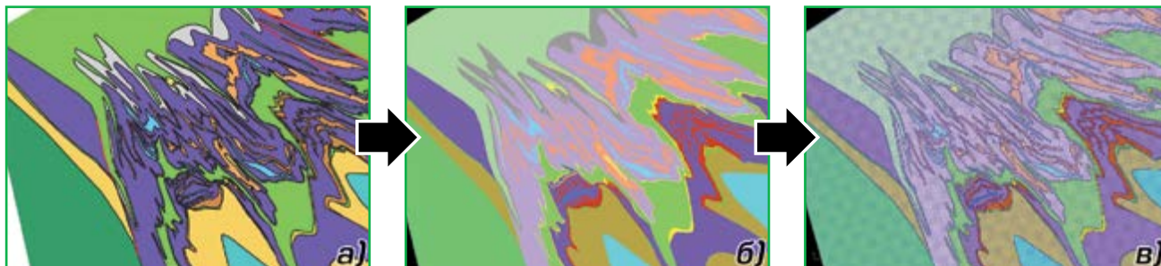
Рис. 1. Создание блочной модели кристаллической части Лебединского месторождения: а) ведущий на предприятии погоризонтный план; б) обработанная и заверенная полигональная модель; в) блочная погоризонтная модель
