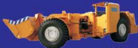
Машина погрузочно-доставочная МоАЗ-4055
