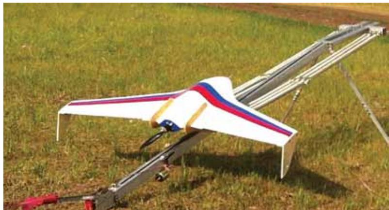
Комплекс БПЛА для аэрофотосъемки «Дельта» перед запуском
