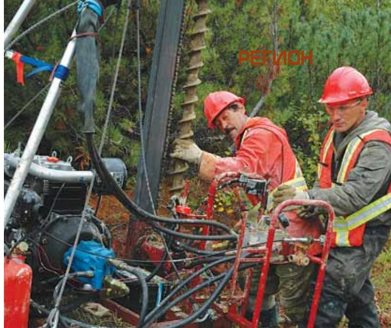
Бурение сейсморазведочных скважин легкими переносными буровыми установками
