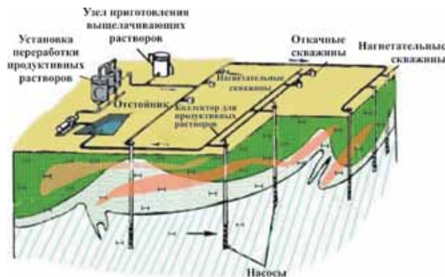
Рис. 1. Принципиальная схема добычи металлов методом подземного выщелачивания
