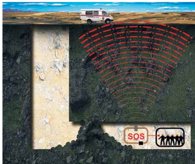
Система беспроводной подземной аварийно-спасательной связи Радиус-3
