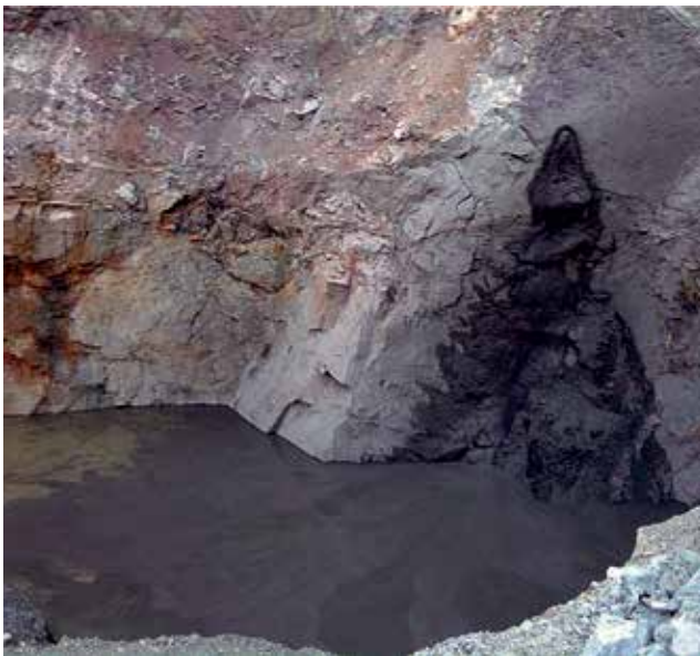
Рисунок 8. Закладка выработанного пространства после выемки придонной части опытного участка
