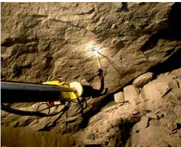
Рис. 3. Зарядка восходящих скважин ЭВВ
