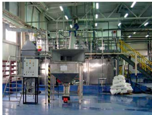
Рис. 5. Модульная установка производства эмульсионных взрывчатых веществ
