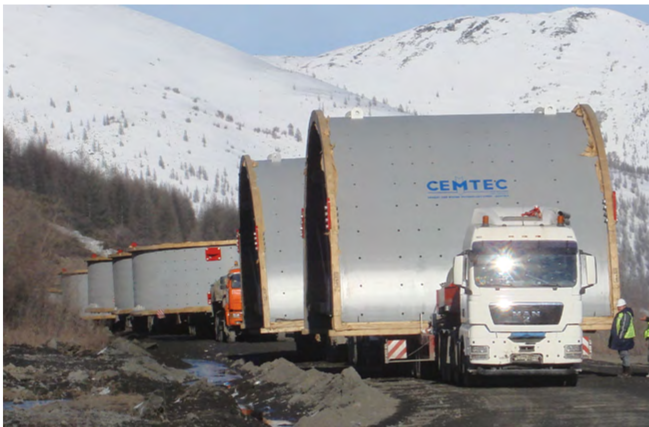
Рис. 6. Транспортировка измельчительного оборудования для ЗИФ по Колымской трассе
