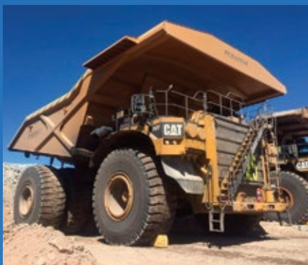
CAT-797F — стальной кузов серии ХР на медном руднике в Чили
