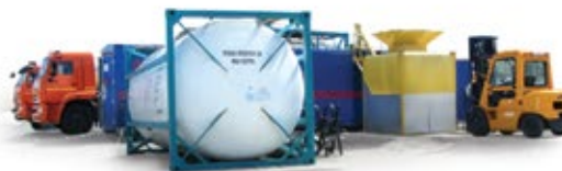
Мобильные заводы по приготовлению полуфабрикатов эмульсионных взрывчатых веществ
