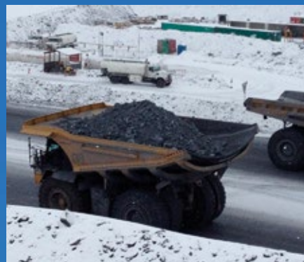
CAT-789C с кузовом серии SDB Duratray на золотодобывающем предприятии в Кыргызстане
