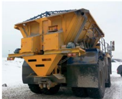
Щебнеразбрасыватель на шасси БЕЛАЗ-7555, -7547
