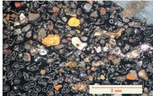
Рис. 1. Вид зерен, оставшихся после обработки концентрата азотной кислотой (боковой свет, насыпной материал)
