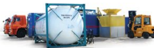
Мобильные заводы по приготовлению полуфабрикатов эмульсионных взрывчатых веществ
