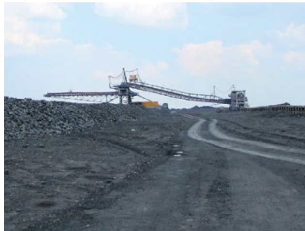
Рис. 2. Отвалообразователь ARsB-5500 формирует первый ярус отвала «Конвейерный»
