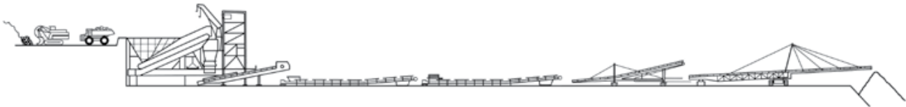
Рис. 4. Схема циклично-поточного вскрышного комплекса
