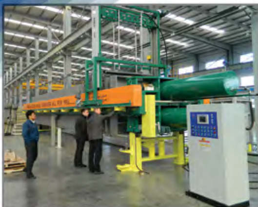
Фильтр-пресс (700 м 2 ) во время приемки на заводе специалистами фабрики ЦОФ «Щедрухинская»
