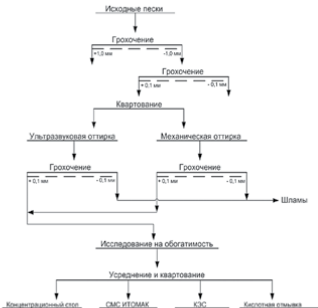
Рис. 5. Принципиальная схема исследований исходных кварцевых песков II Каменского месторождения
