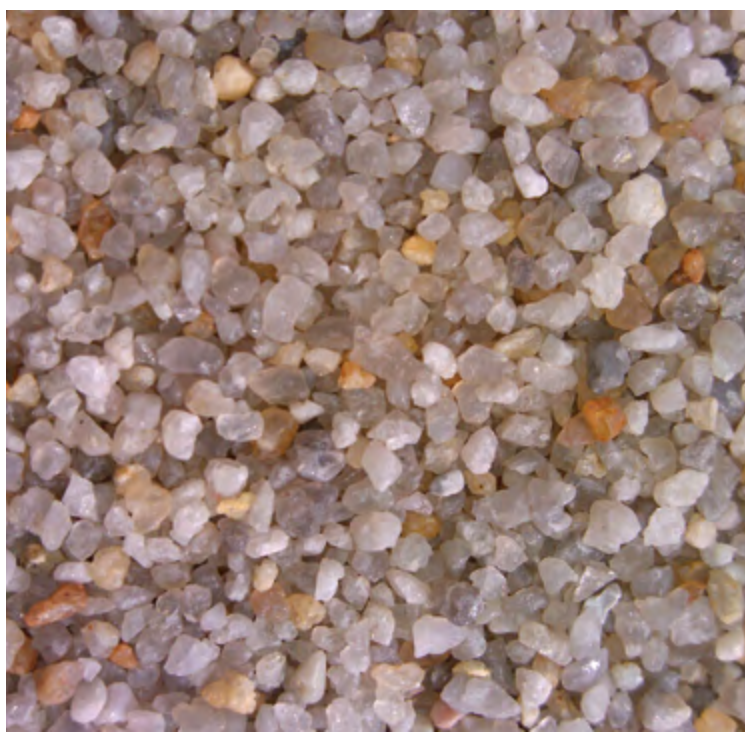
Рис. 1. Зерна кварца белое (слева) и бесцветное (справа). Просыпка, косой свет, без анализатора, 9°
