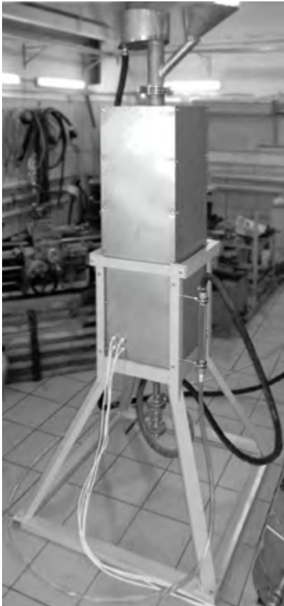
Рис. 4. Установка ультразвуковой очистки сыпучих материалов МОД НО-156 компании «Александра-Плюс»
