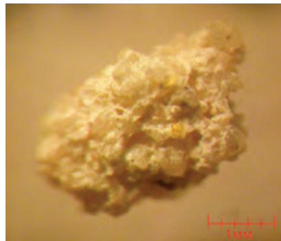
Рис. 2. Зерна кварца, связанные между собой полевым шпатом. Просыпка, косой свет, без анализатора, 20°
