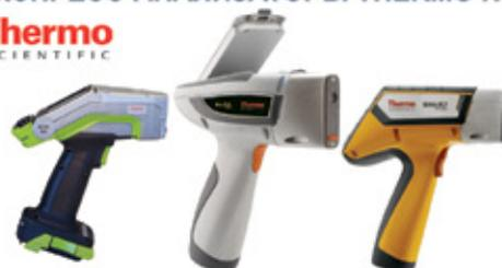
Портативные РФ экспресс-анализаторы **Thermo NITON** для точного анализа химического состава геологических образцов на различных этапах разведки и разработки месторождений:
