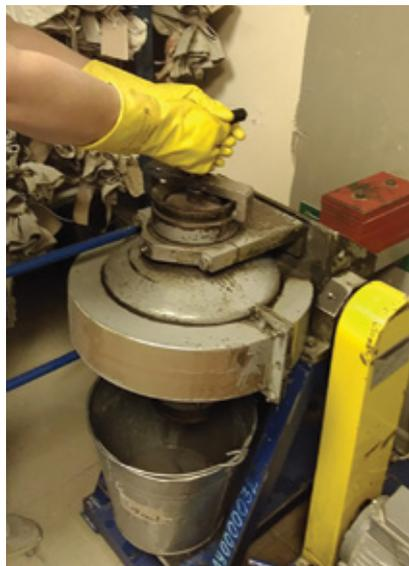
Рисунок 2. Выгрузка пробы руды после измельчения на шаровой мельнице МШЛ-7
