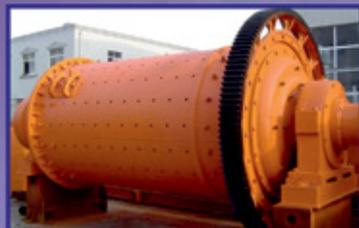
Мельницы для измельчения руды, шлаков, клинкера с высоким коэффициентом дробления и малой зернистостью перерабатываемого материала.
