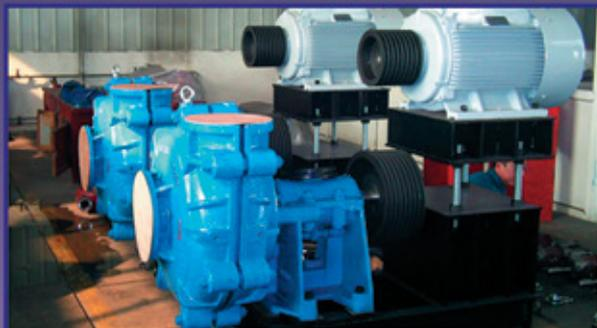
Насосы и ЗИП для абразивных гидросмесей типа WARMAN серии AH, AHR, HH, M, L, SP, SPR и т. д.
