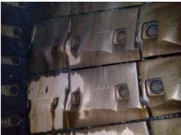
Рис. 1. Линия износа футеровки
