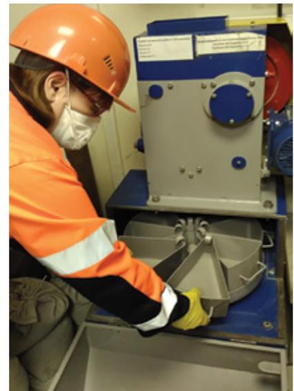
Рисунок 3. Агрегат дробильно-делительный
