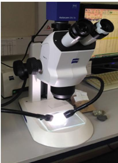
Рисунок 1. Стереомикроскоп Stemi-508
