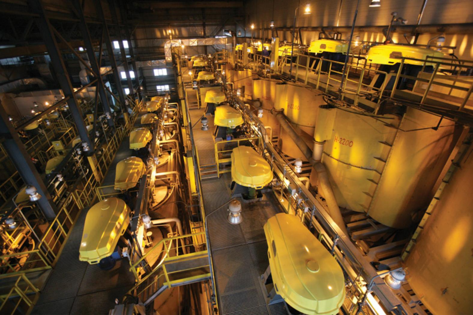
Во флотационном цехе фабрики работают 36 флотомашин Outotec Tank Cell, обладающих очень быстрой флотационной кинетикой
