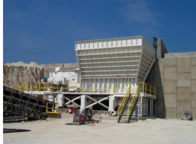
Основным преимуществом дробилки-питателя является то, что материал поступает горизонтально под дробильный вал. Бункерная установка ниже по высоте, чем другие виды дробилок, а это снижает общий объем капиталовложений, включая стоимость с учетом монтажа
