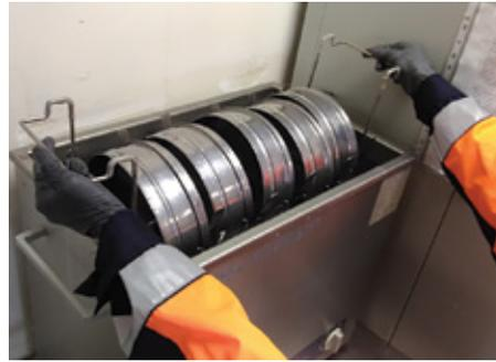
Рисунок 5. Очистка аналитических сит в ультразвуковой ванне
