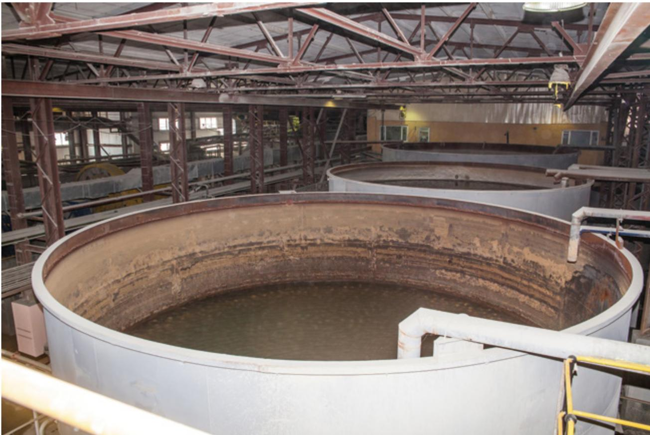
извлечение золота в раствор 81,14 % (без учета потерь с сорбентом и жидкой фазой). При этом содержание золота в общих отвальных хвостах схемы, включая кек выщелачивания, составило 0,26 г/т.
