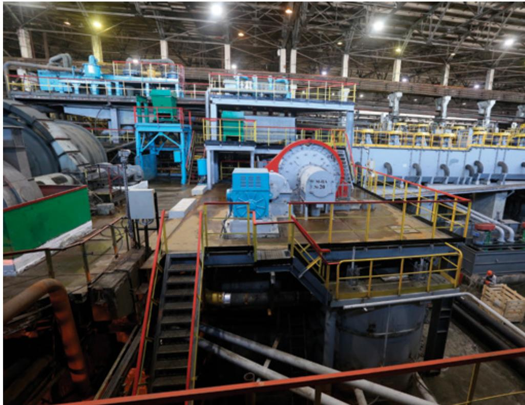
лективном цикле флотации запущены две параллельно установленные флотомашин, скомплектованные из флотомашин производства СП ЗАО «ИВС», фирмы Outotec, контактных чанов производства ЗАО «Усольмаш» и насосного оборудования фирмы Metso Minerals. Благодаря такому техническому перевооружению планирование поступления и переработки руды стало более гибким, а ее переработка — эффективнее.
