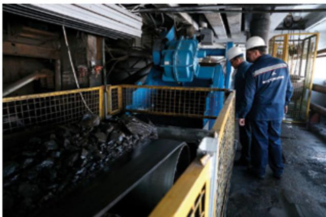
электронные весы на 110 т. Теперь взвешивание производится непосредственно под разгрузочными течками. Появилась возможность исключить процесс дозирования, тем самым сократив число маневров тепловозов.
