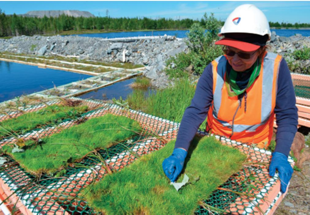
Биоплато. Эксперимент по применению технологии биоремедиации: использование компонентов природной среды при очистке карьерных вод
