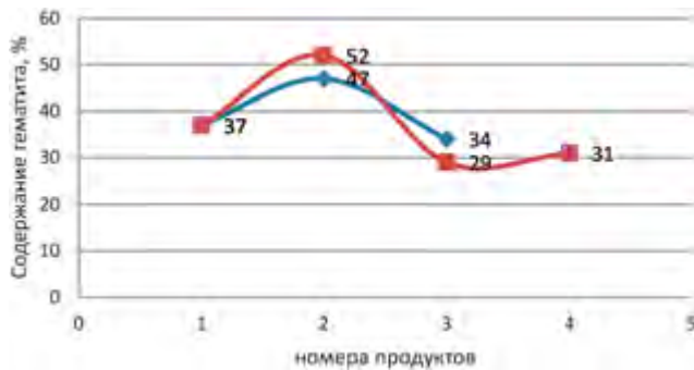
Рис. 5. Распределение гематита в продуктах обогащения магнитной сепарации (синяя) и гравитации (красная)
