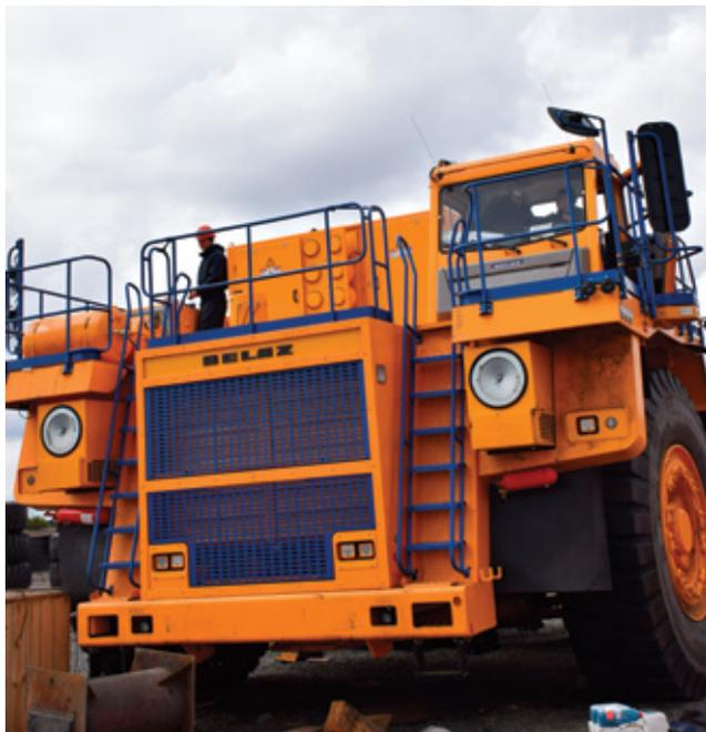
элементов и агрегатов: установка эффективного 1 600-сильного двигателя CUMMINS с электронным управлением, установка современной трансмиссии переменного-постоянного электротока, также управляемой электроникой. Оборудованы системы контроля загрузки, давления в шинах, усиленная рама, а для комфорта водителя имеются видеорефлекторы четырехстороннего обзора.
