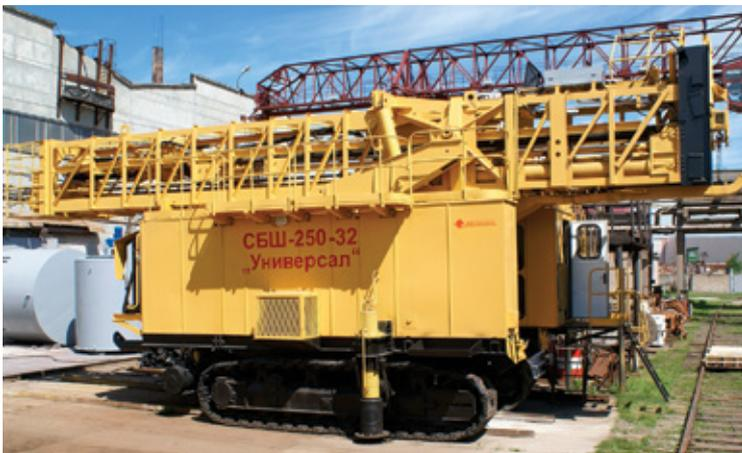
Напомним, что СБШ-250-32 — это самоходный станок, разработанный для бурения скважин шарошечными долотами в породах крепостью 4 — 20 ед. по шкале проф. М. М. Протодьяконова с высокой абразивностью под заряд взрывчатых веществ на открытых горных работах. Максимальный диаметр скважины достигает 270 мм. Скорость передвижения станка составляет от 0 до 1,4 км/ч с возможностью плавной регулировки хода.
