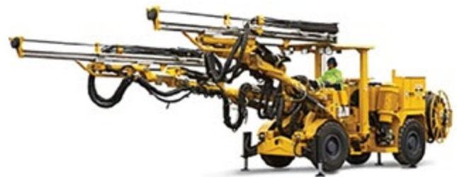
Фото 2. Буровой станок ATLAS COPCO ROCKET BOOMER 282 (© www.atlascopco.com)
