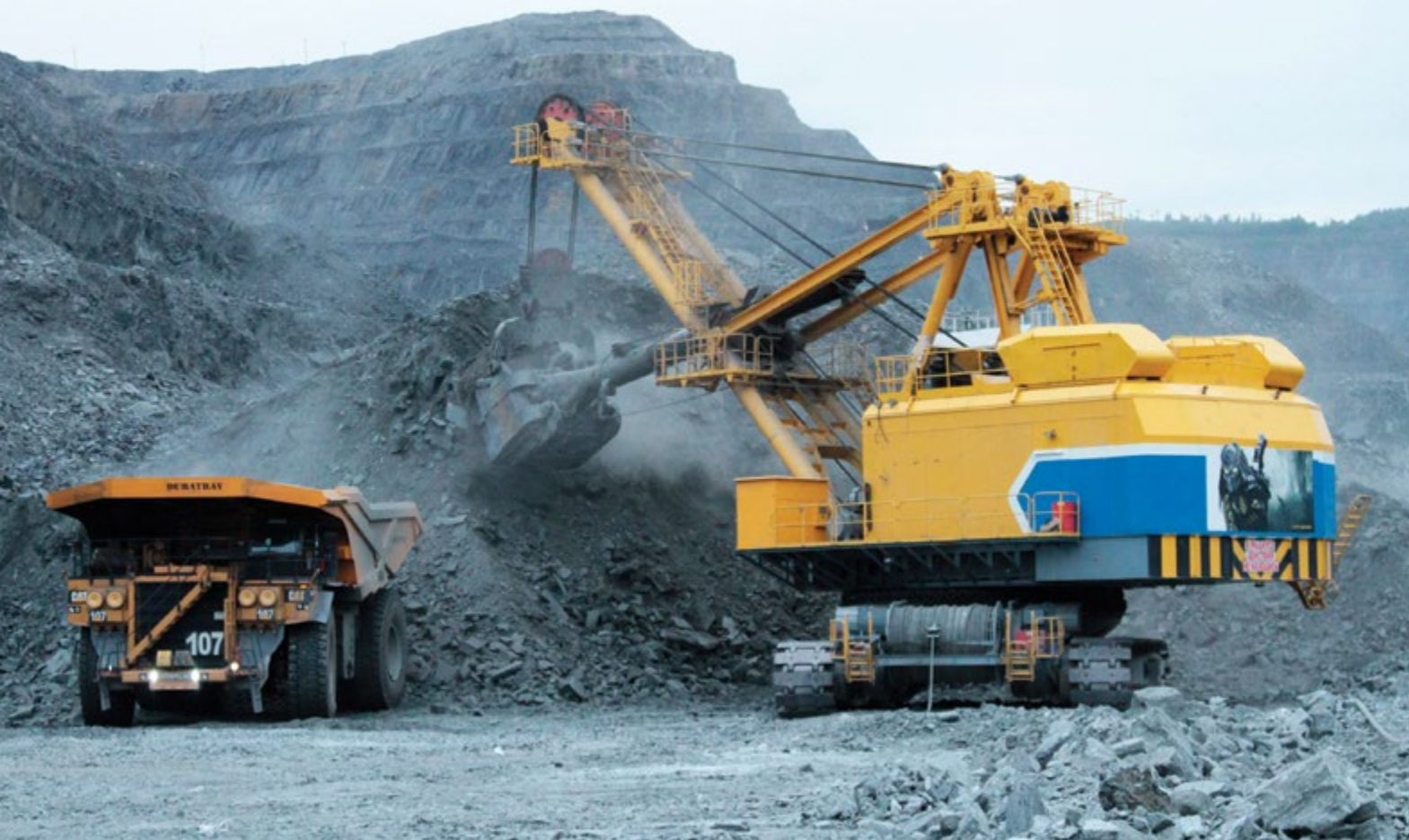
Большой экскаватор ЭКГ-20К
