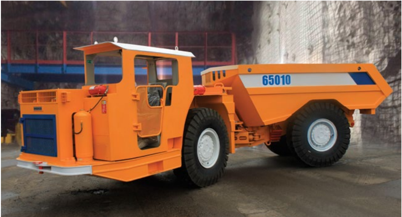
Шахтный самосвал MOA3-65010 грузоподъемностью 15 т
