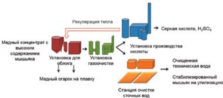
Рис. 3. Технологическая схема обжига, газоочистки, сернокислотного производства и станции очистки сточных вод завода DMH компании Codelco в г. Калама, Чили
