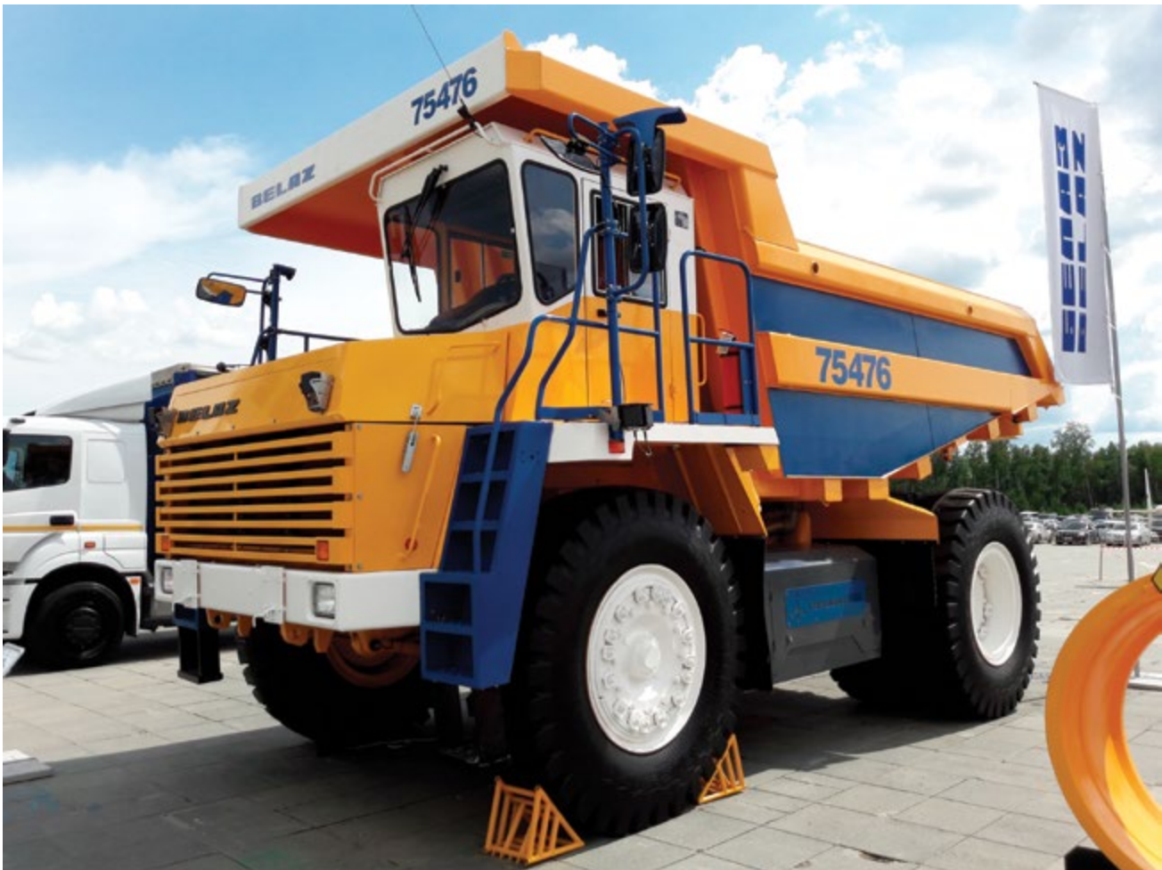
Карьерный самосвал БЕЛАЗ-75476 с газовым двигателем «Кунгур-550»
