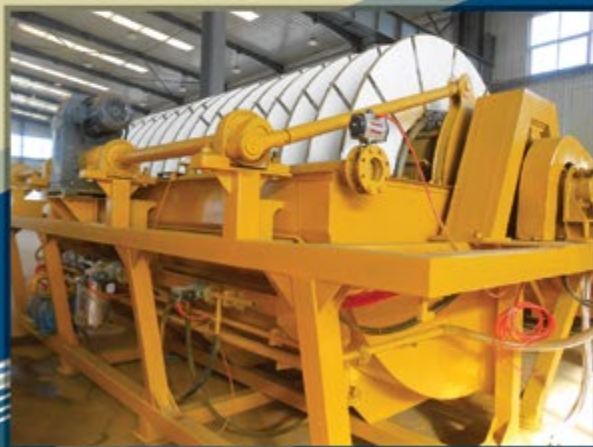
Фильтр-пресс (700 м 3 ) во время приемки на заводе специалистами фабрики ЦОФ «Цедрухинская»
