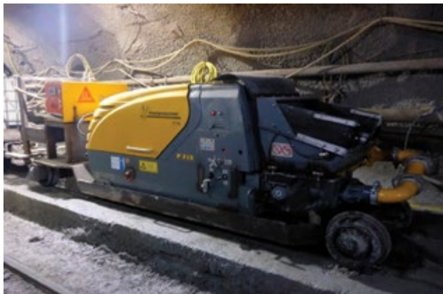
Фото 8. Бетононасос PUTZMEISTER P 715 SE на вагонетке (www.moertelmaschinen.de)
