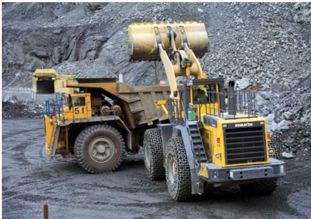
Погрузка руды фронтальным погрузчиком Komatsu WA 900 с перегрузочного пункта
