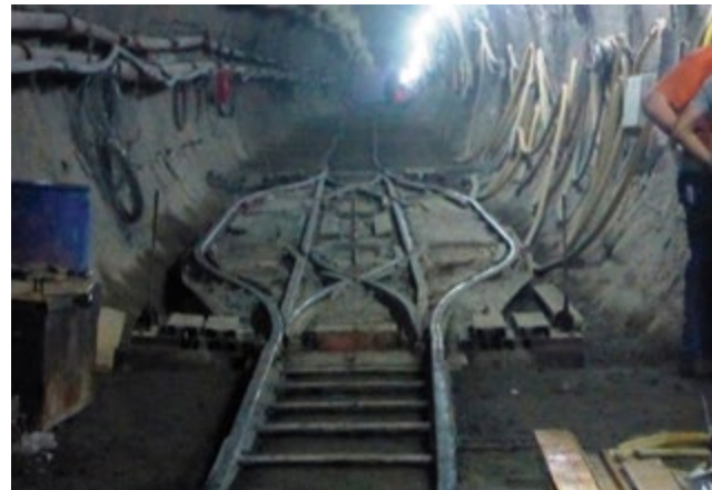
Фото 5. Трехходовая стрелка MASCHINENBAU MARK (www.maschinenbau-mark.de)
