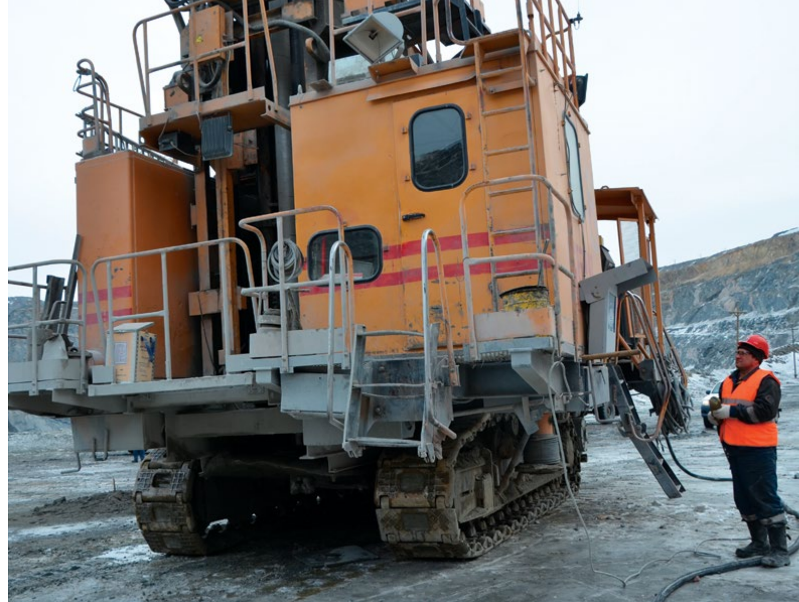
Оператор использует систему высокоточного позиционирования буровых станков
