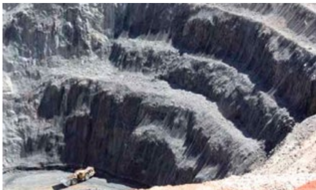
Рис. 1. Драпировка «Стилгрид HR» на бортах золоторудного карьера, компания Barrick Ltd
