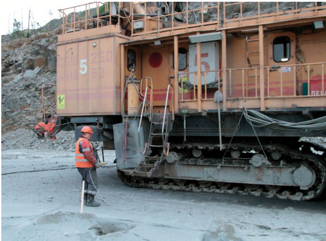
Машинист наводит буровой станок на скважину с помощью планшета
