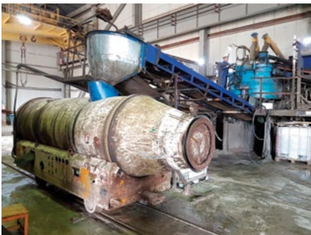
Фото 10. Миксер при наполнении фиброармированным бетоном
