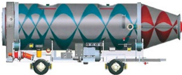
Рисунок 7. Дополнительный миксер, тип BM4, компании KARL-H. MUHLHAUSER GmbH & Co. KG (© www.tunnelling-equipment.com)
