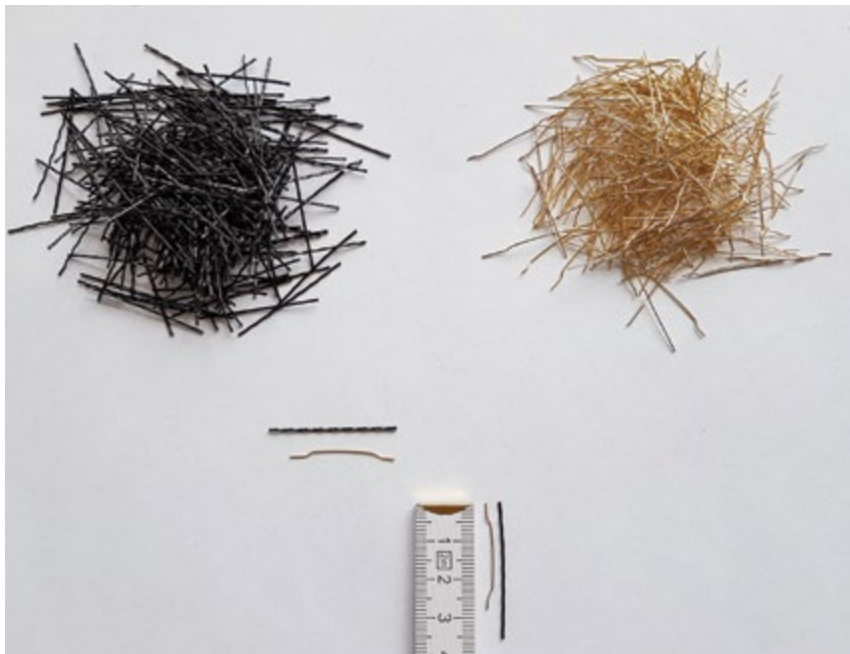
Фото 12. Геометрия полимерных (слева) и стальных фибр (справа)
