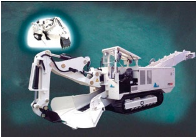
Фото 3. Туннельный погрузочный экскаватор ITC TEREX SCHAEF 120 F4 (© www.itcsa.com)
