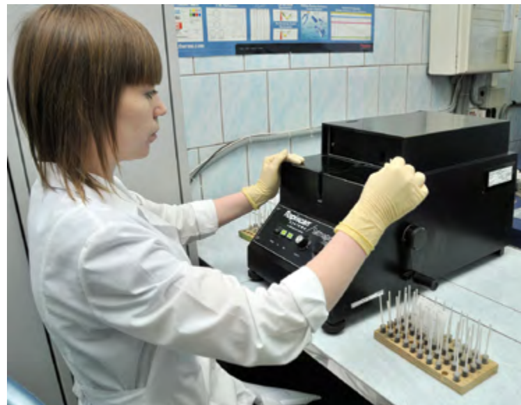
Анализ магнитной фракции железных руд с помощью магнитометра Satmagan
