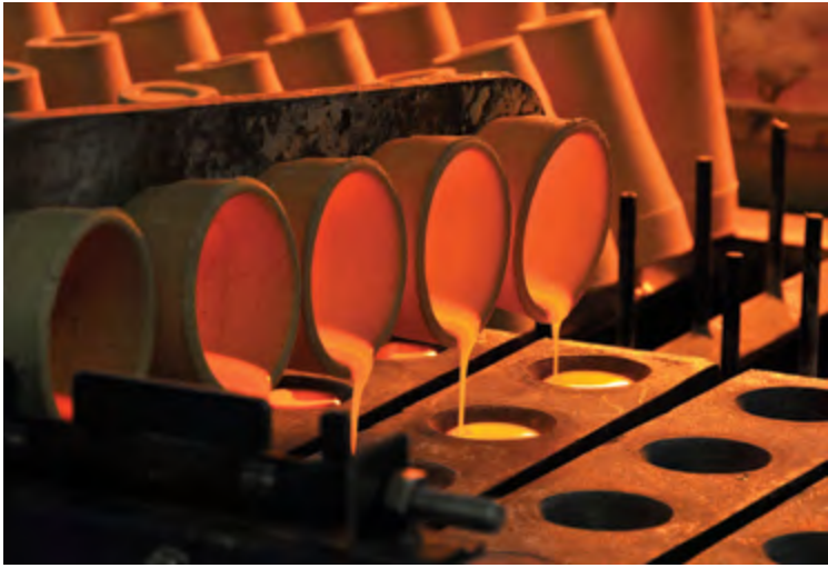
Пробирный метод остается основным при определении благородных металлов в рудах и продуктах их переработки
