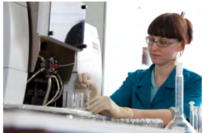
Анализ растворов на золото и серебро атомно-абсорбционным методом
