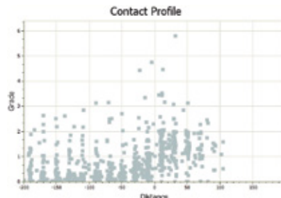
Рисунок 14. Профиль по контакту, который отображает зависимость расстояния от содержания, обычно он более «шумный», чем традиционный график профиля, он показывает разброс на 0 м расстоянии, что означает, что происходят значительные изменения
