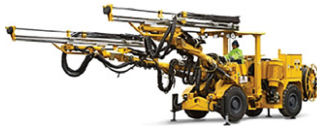
Фото 2. Буровой станок ATLAS COPCO ROCKET BOOMER 282 (© www.atlascopco.com)
