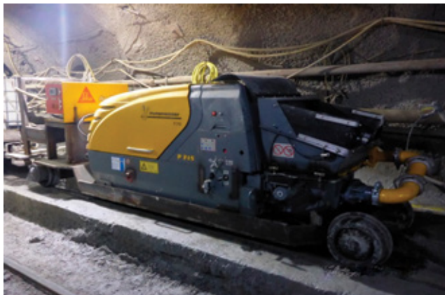
Фото 8. Бетононасос PUTZMEISTER P 715 SE на вагонетке (www.moertelmaschinen.de)
