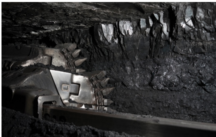
На «Первомайской» эксплуатируется единственный в РФ струговый комплекс производства Viscugus Europe GmbH, Германия (сегодня — компания CATERPILLAR)
