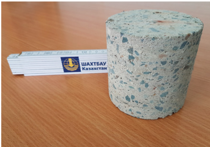
Фото 11. Бетонный керн, подготовленный к испытаниям, изъятый из набрызг-бетонной оболочки на подземном участке; данный бетонный керн имеет размеры 100 x 100 мм
