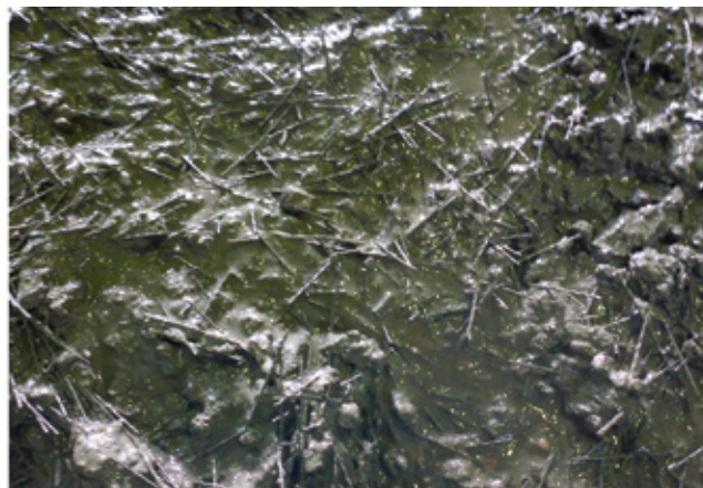
Фото 13. Нанесенная бетонная оболочка (слева со стальной фиброй, справа — с полимерной)
