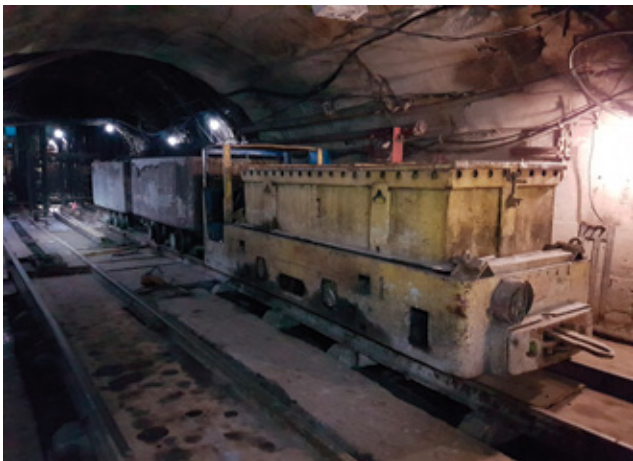
Фото 4. Используемые ДГОК локомотивы и вагонетки для транспортировки рудной массы
