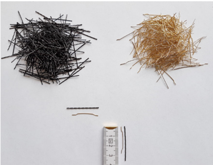
Фото 12. Геометрия полимерных (слева) и стальных фибр (справа)
