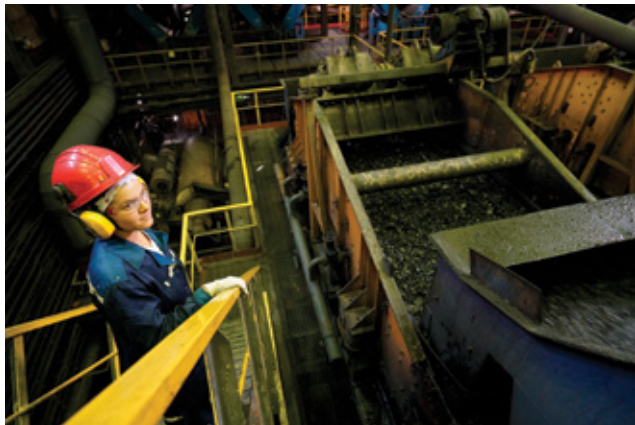
Аппаратчик углеобогащения контролирует процесс обезвоживания концентрата отсадочной машины
