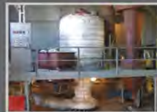
СУШИЛКИ ВИХРЕВЫЕ для сушки мелкодисперсных материалов с низким удельным весом (микросфера и прочее) и влажностью до 40-50 %.
