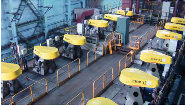
Секция флотационной доводки магнетитовых концентратов на Ингулецком ГОКе, Украина
