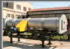
СУШИЛКИ БАРАБАНЫЕ для сушки различных влажных материалов в непрерывном режиме. Топливо – газ, дизельное.
