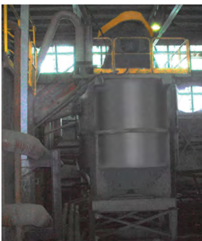
Оттирочный комплекс ОФК-15 РИФ, Учалинский ГОК
