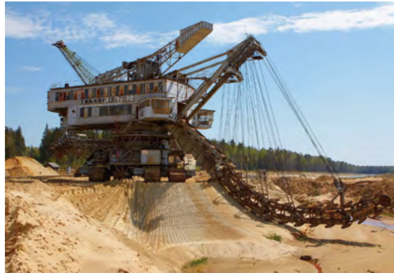
Рис. 1. Работа цепного экскаватора TAKRAF с нижним черпанием
