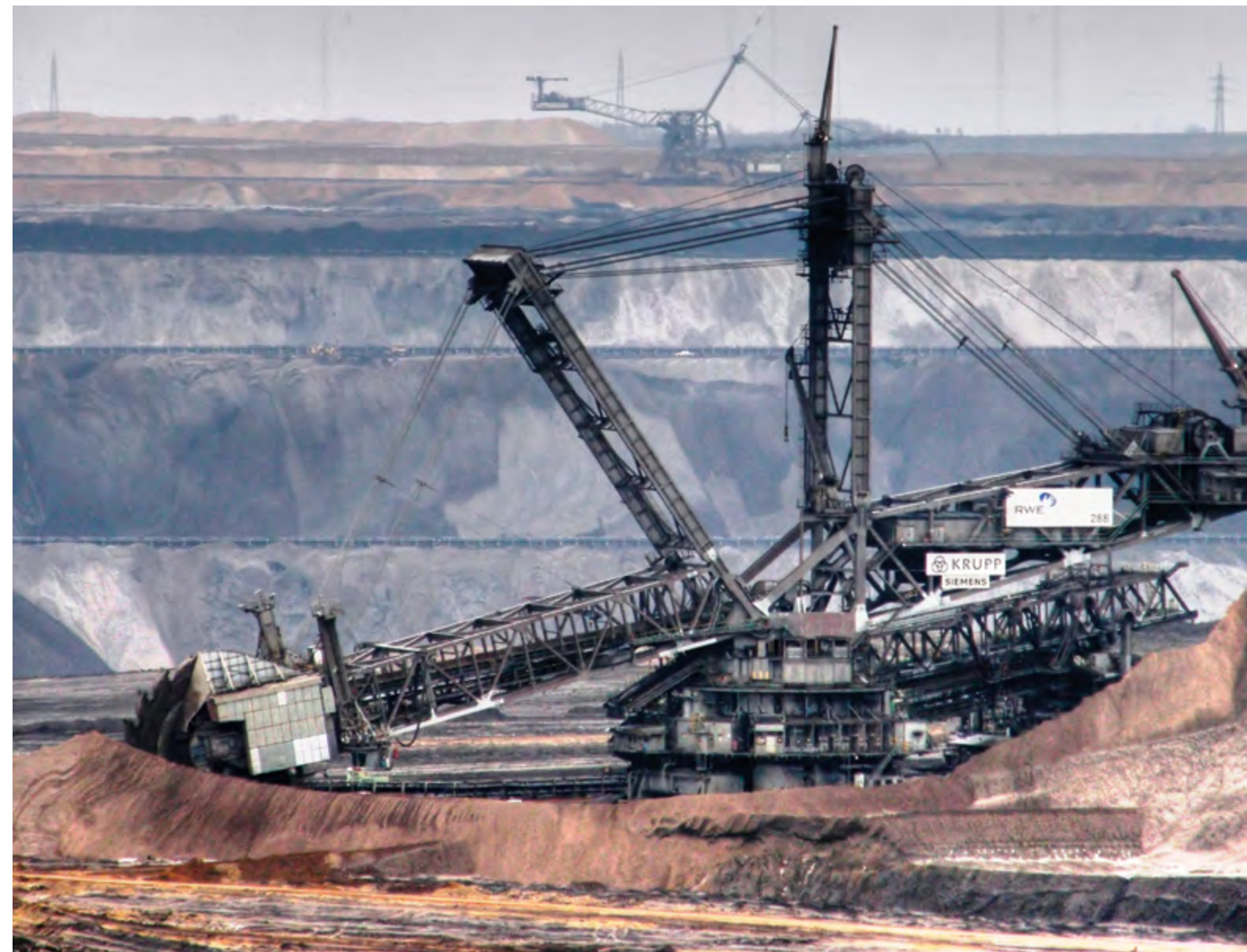
Рис. 2. Работа роторного экскаватора с верхним черпанием
