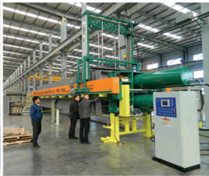
Фильтр-пресс площадью 700 м 2 во время приемки на заводе специалистами фабрики ЦОФ Щедрухинская
