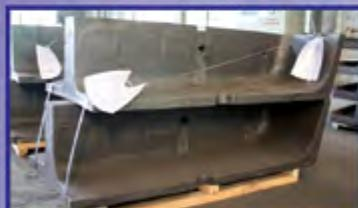
Изготовим футеровку для мельниц из материала хром-молибден. Проводится визуальная проверка ультразвуковой дефектоскопией и магнитными порошками.
