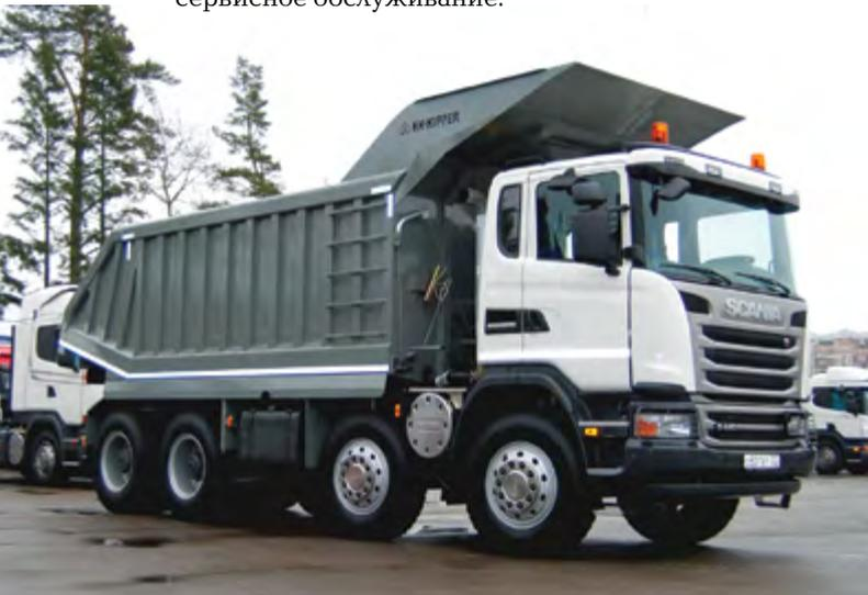
Уникальный самосвал Scania G440 с колесной формулой 8x8, созданный специально для решения комплекса задач с учетом специфики отрасли, предназначен для перевозки больших объемов горной массы и работы в карьерах и на месторождениях с непроходимыми дорожными условиями.
