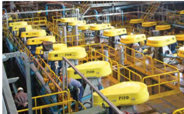
Рис. 1. Реконструкция ОФ на базе флотомашин РИФ
