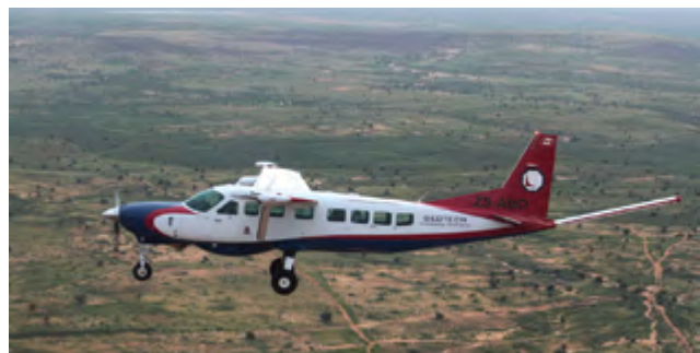
Рис. 7. Geotech самолет с тремя разнесенными магнитными датчиками и тремя спектрометрами на борту
