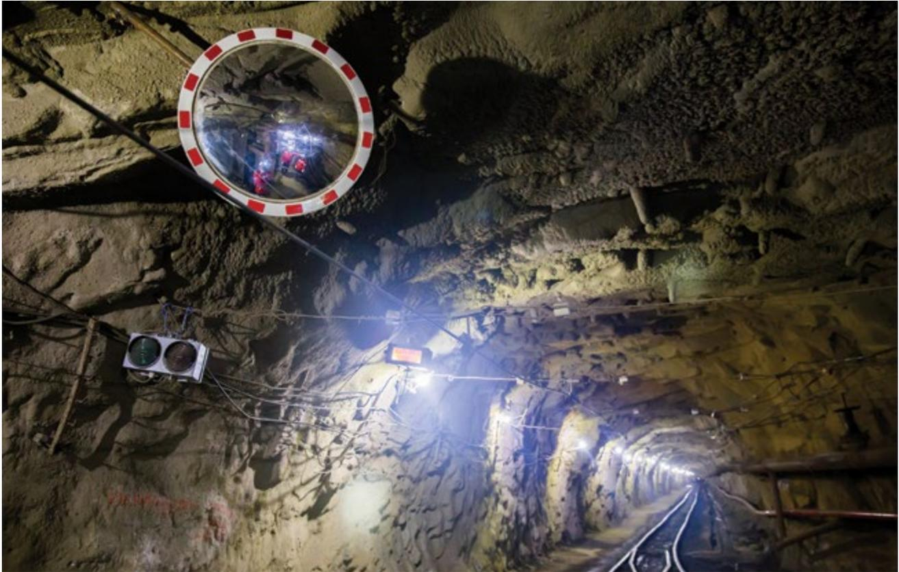
В горных выработках Шерегешской шахты установлены зеркала для безопасности и контроля передвижения электропоездов
