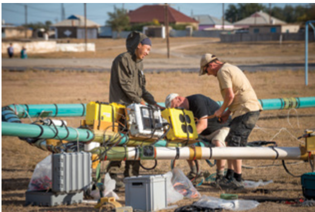
Рис. 4. Раскладка системы SkyTEM™ перед съемкой
