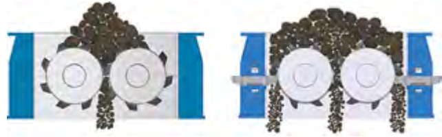
Рис. 2. CenterSizer (центральное дробление) и SideSizer (боковое дробление)
