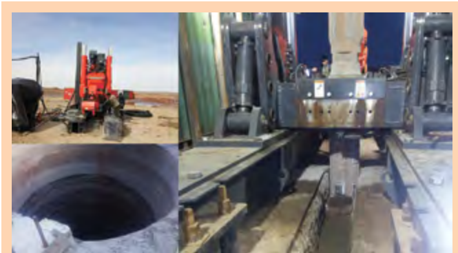
Буровой станок Rhino 2007DC для проходки восстающих выработок
