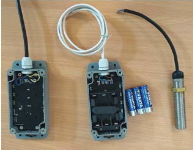
Рис. 4. Система беспроводной передачи данных с датчика частоты вращения бурового става (на фото слева направо: блок приемника, блок передатчика, комплект резервных батарей, штатный индукционный датчик)
