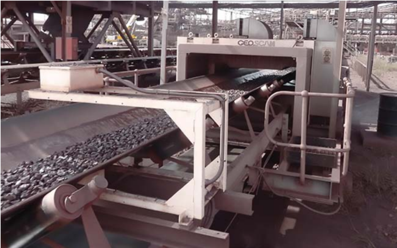
Рисунок 2. Датчик объемной сортировки руды GeoScan. Источник: Scantech
