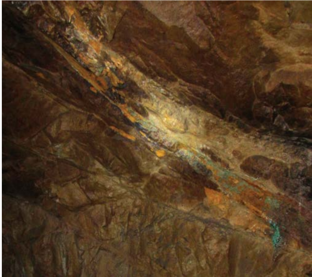
Золотая жила в кровле горной выработки (гор. 650 м)
