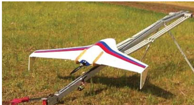
Комплекс БПЛА для аэрофотосъемки «Дельта» перед запуском
