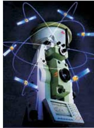
Особенностью тахеометров TPS1200+ является возможность закрепления спутниковой антенны/приемника на тахеометре — система SmartStation. Все, что нужно для модернизации, — специальная радиоручка, GNSS-антенна, программа для записи GNSS-данных. Антенна с радиоручкой непосредственно устанавливается на прибор. SmartStation объединяет в себе функции тахеометра и GNSS-приемника, позволяя тем
