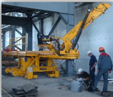
Механизированные манипуляторы подачи/выгрузки футеровки от самых простых 3х-осных, до уникальных 8и-осных комплексов грузоподъемностью до 4 500кг.
