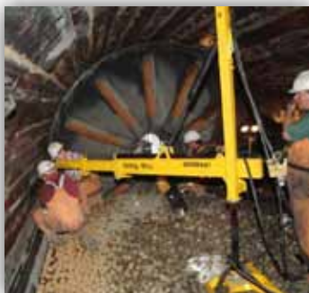
Классические ручные манипуляторы грузоподъемностью от 200 кг.
