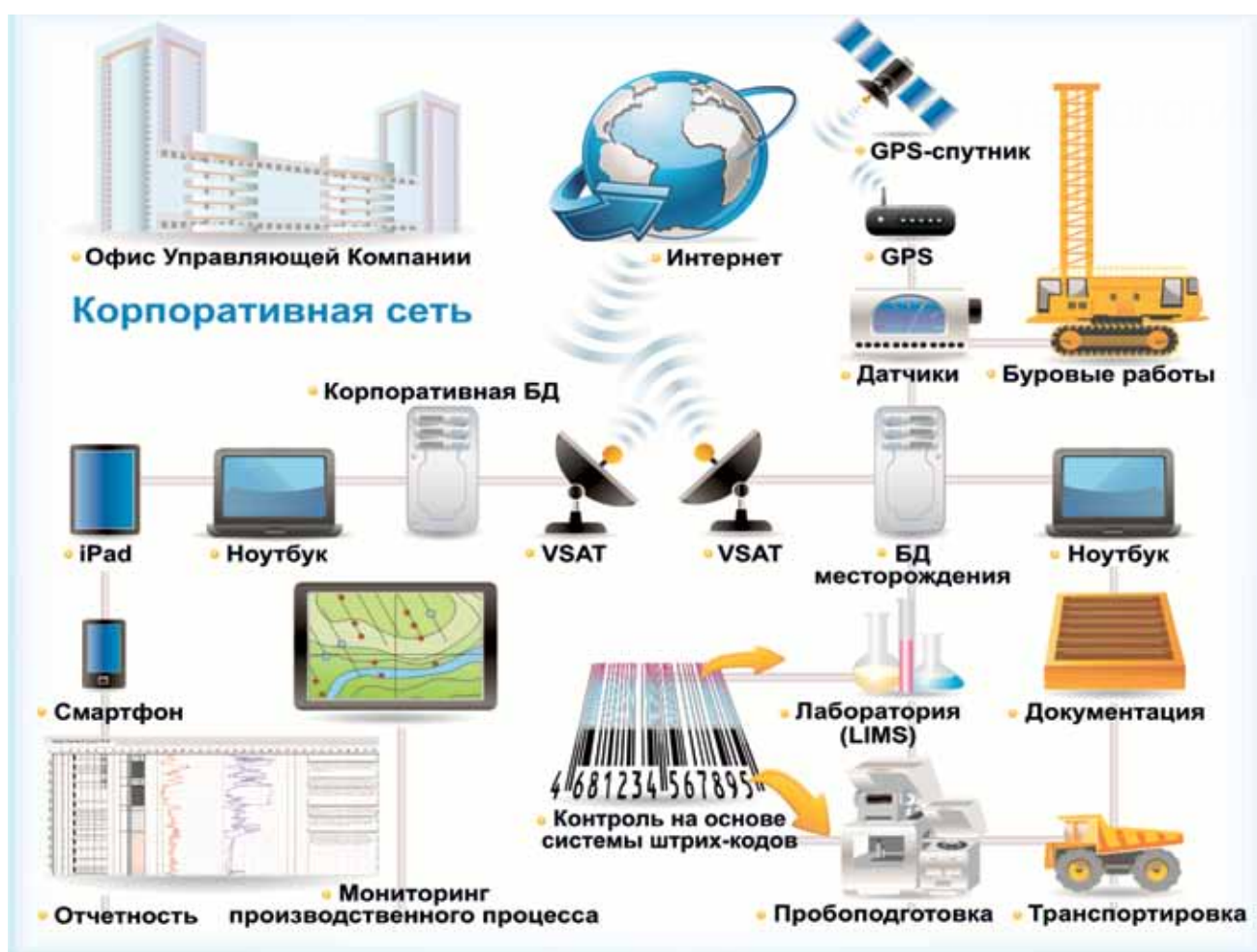
Рис. 2. Укрупненная схема автоматизации ГРП на основе системы АГР
