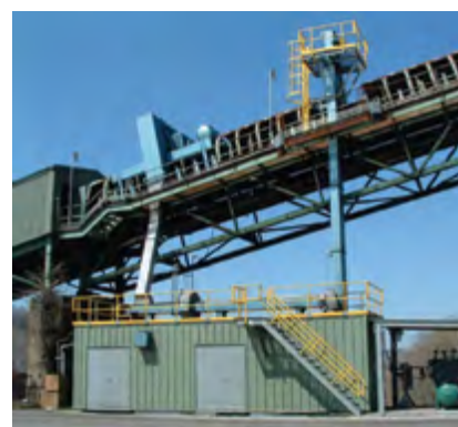
Рис. 1. Система отбора и подготовки проб дробленной руды
