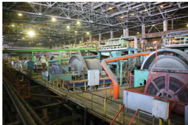
КМД-2200Т) дробилках и трехстадиальный цикл измельчения в стержневых (МСЦ 3 200 x 4 500) и шаровых (МШЦ 3 200 x 4 500, МШЦ 4 500 x 6 000) мельницах.
