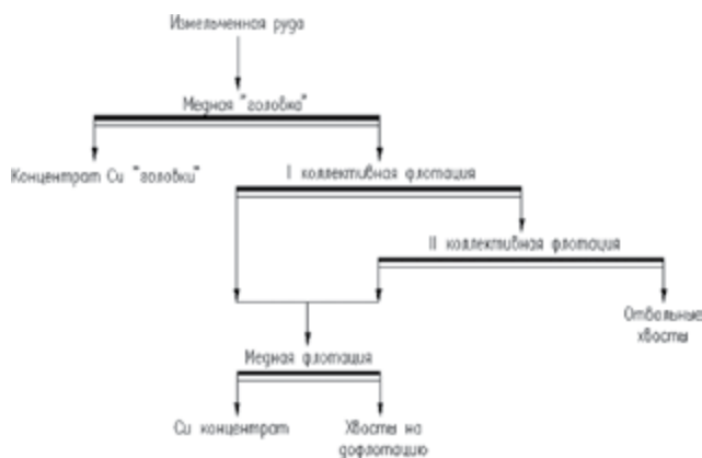
Рис. 2. Альтернативная схема обогащения руды на Гайской ОФ
