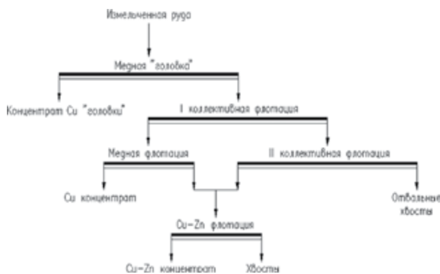
Рис. 1. Принципиальная схема обогащения руды на Гайской ОФ
