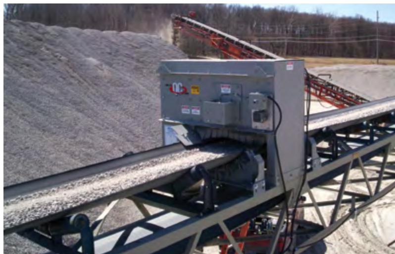
Рис. 4. Маятниковый пробоотборник угля и щебня серии QC360, расположенный сверху конвейера
