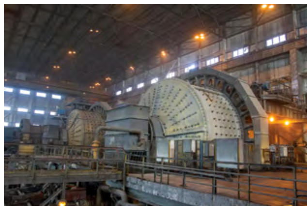
КМД-2200Т) дробилках и трехстадиальный цикл измельчения в стержневых (МСЦ 3 200 x 4 500) и шаровых (МШЦ 3 200 x 4 500, МШЦ 4 500 x 6 000) мельницах.
