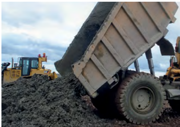
Рис. 2. Доставка обезвоженных глинистых хвостов на складирование
