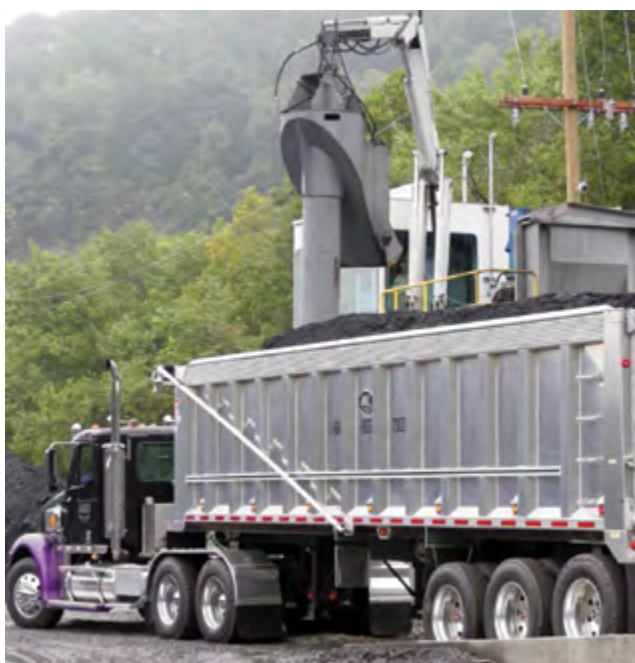
Рис. 5. Шнековые системы пробоотбора: быстрое и аккуратное опробование угля в самосвалах
