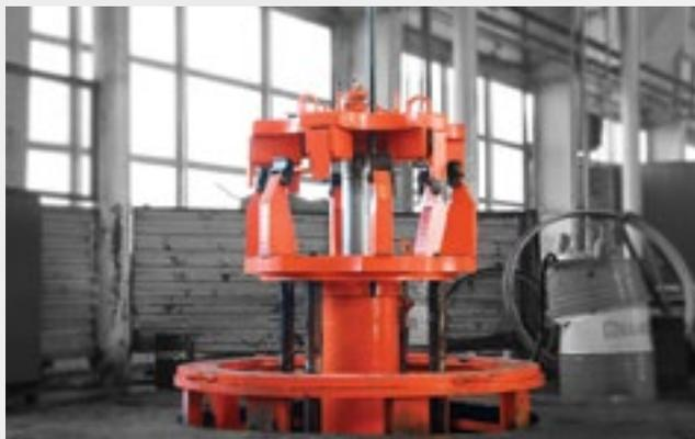
Шиномонтажный стенд для разборки и сборки крупногабаритных колес, установленный в прямом
