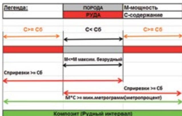
Рисунок 3. Схема формирования рудных интервалов на основе данных рядового опробования
