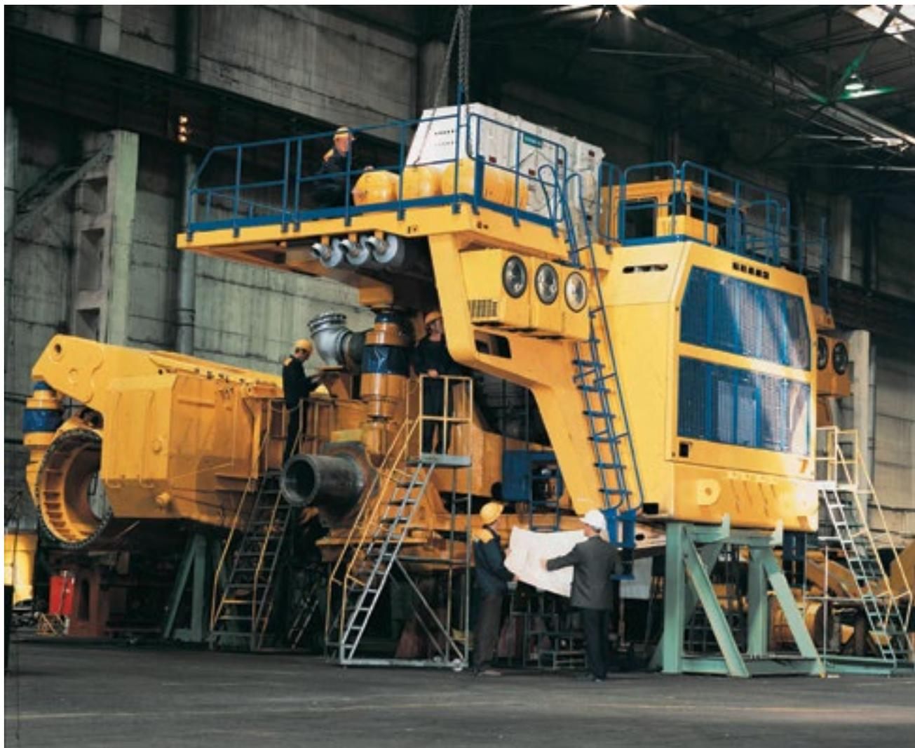
Изготовление первого образца карьерного самосвала серии БЕЛАЗ-7560 в экспериментальном цехе ОАО «БЕЛАЗ»
