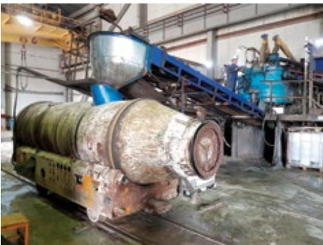
Фото 10. Миксер при наполнении фиброармированным бетоном
