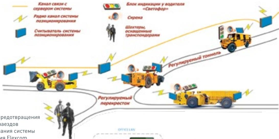
Рис. 2. Система предотвращения столкновений и наездов на базе оборудования системы позиционирования Flexcom
