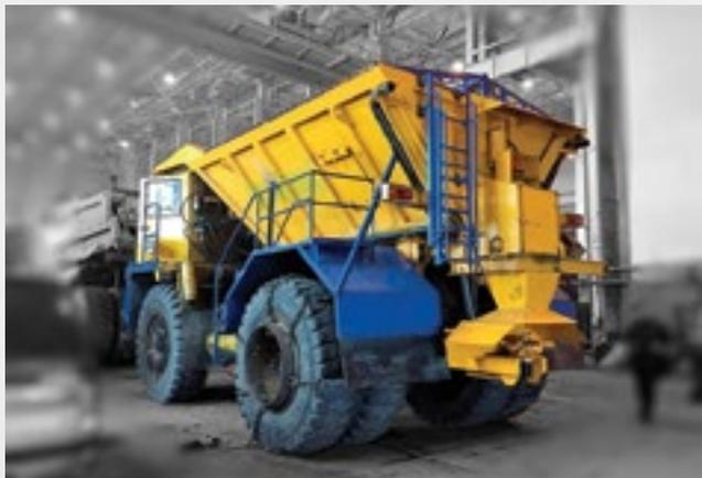
Навесное устройство щелперразбрасыватель РЗ-7547Б на шасси БЕЛАЗ-7547
