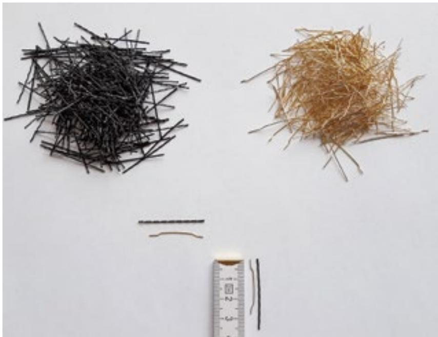
Фото 12. Геометрия полимерных (слева) и стальных фибр (справа)
