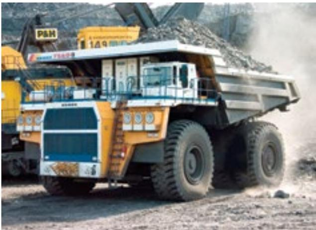
Головной образец карьерного самосвала серии БЕЛАЗ-7560 проходит эксплуатационные испытания в филиале «Бачатский угольный разрез» ОАО «УК «Кузбассразрезуголь»
