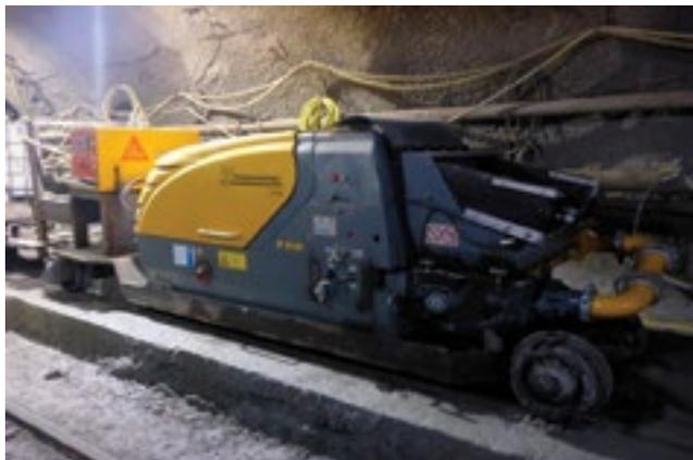
Фото 8. Бетононасос PUTZMEISTER P 715 SE на вагонетке (www.moertelmaschinen.de)
