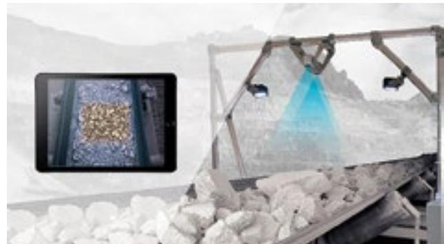
**BeltMetrics™** — это новый инструмент анализа фрагментации руды, который использует стереоизображения для постоянного анализа фрагментации руды на конвейерных лентах предприятия. Он также может детектировать пустые ленты, предупреждая персонал о наличии возможных проблем
