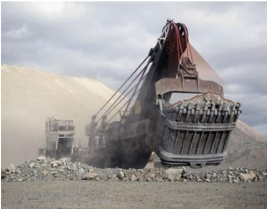
**ShovelMetrics™** использует алгоритмы глубокого анализа и защищенную промышленную камеру, чтобы оценить распределение размеров руды в ковше экскаватора
