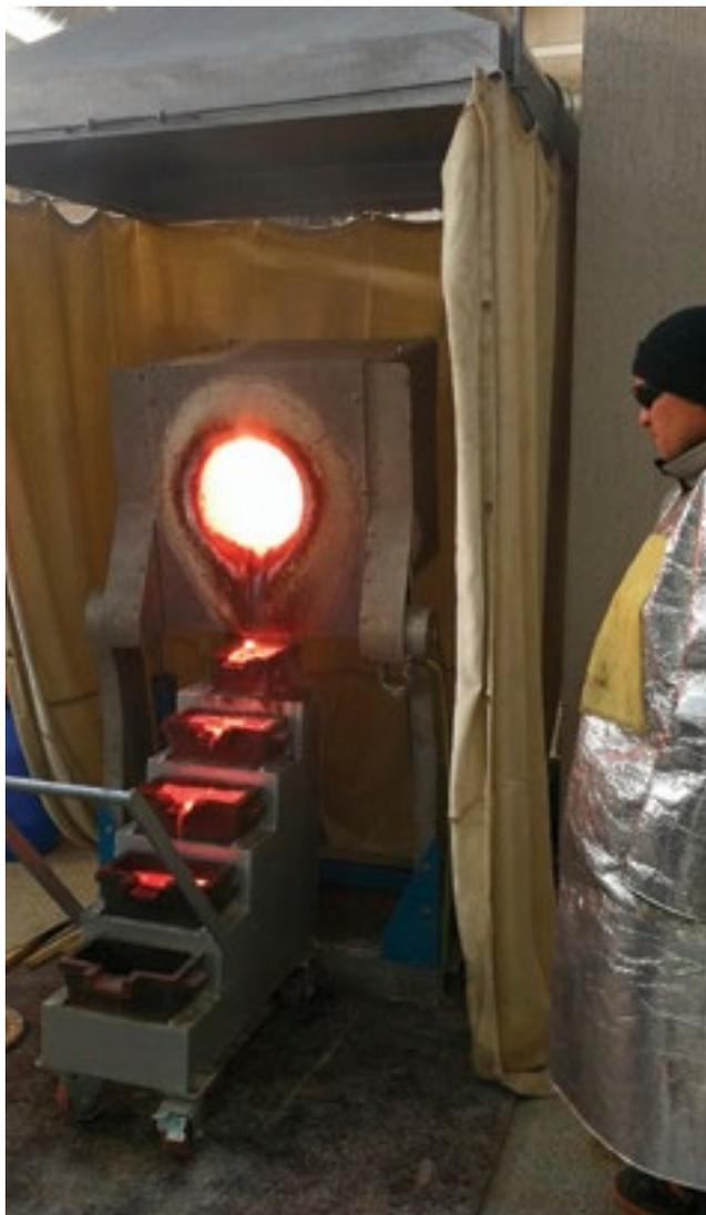
Фабрика по переработке ТМО в Аксу. Плавка слитков
