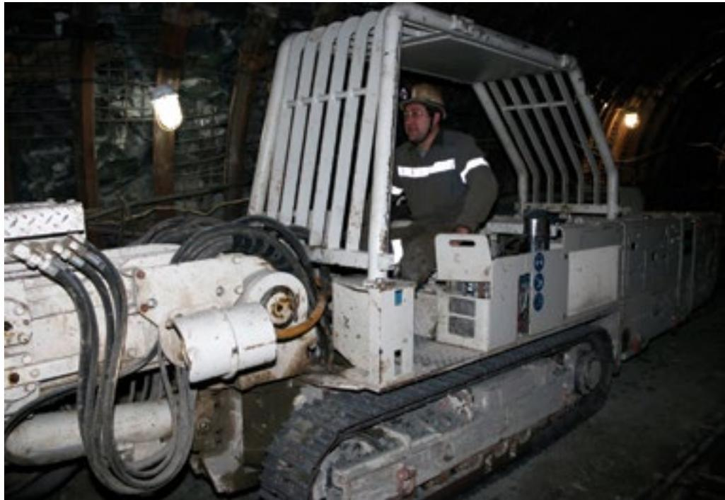
Собрать, запустить и вывести машину на практические технологические параметры — на это коллективу участка проходческих и очистных работ № 2 под руководством Айбека Баймульдина потребовалось полтора месяца. MF-300 была неопробованной экспериментальной моделью как для ее изготовителя, немецкой фирмы Hazemag, так и для шахтеров ДГОКа. Этот вариант машины создан с рядом изменений на стандартной базе — специально для условий Донского комбината.
