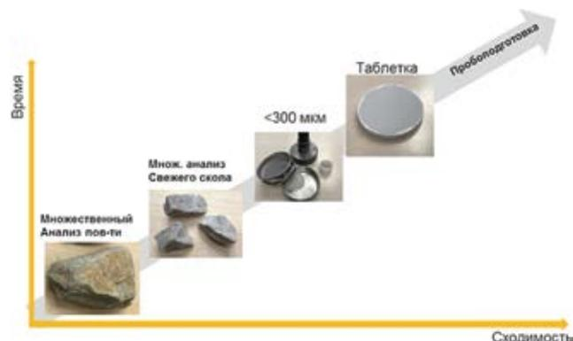
Рис. 2. Зависимость сходимости результатов от пробоподготовки и времени
