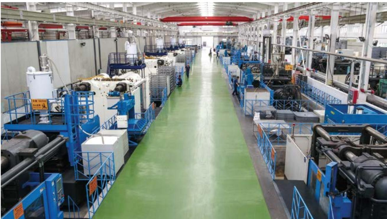
Инжекционные машины для производства фильтровальных плит
