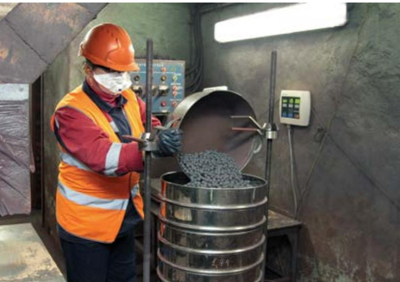
Определение гранулометрического состава железорудных окатышей
