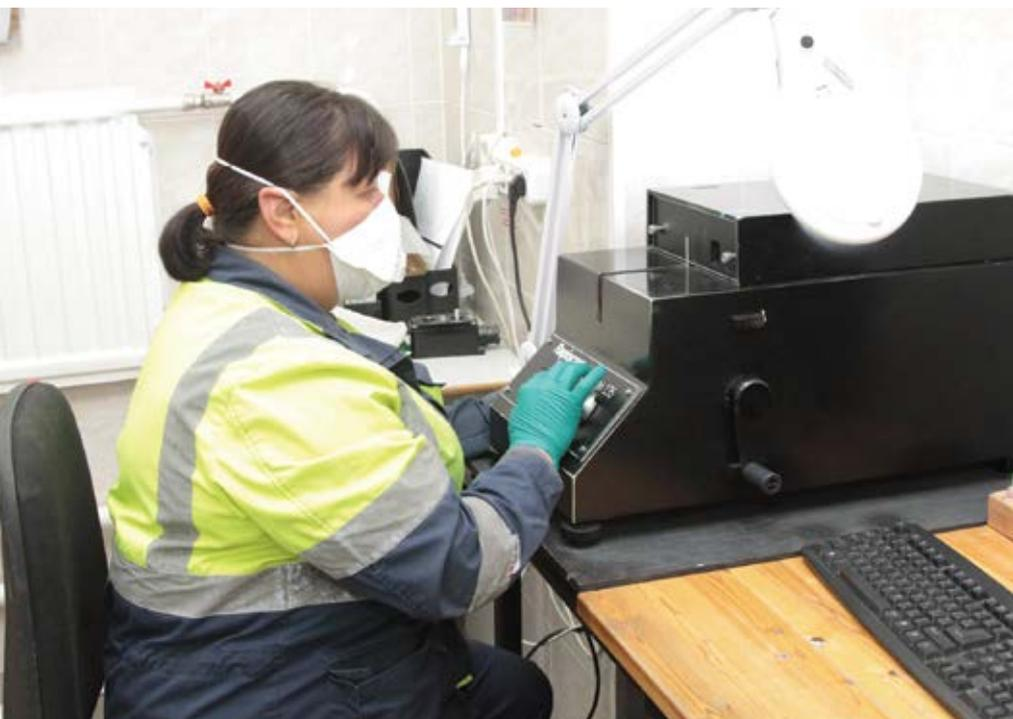
Измерения на содержание железа магнетитового на анализаторе Satmagan
