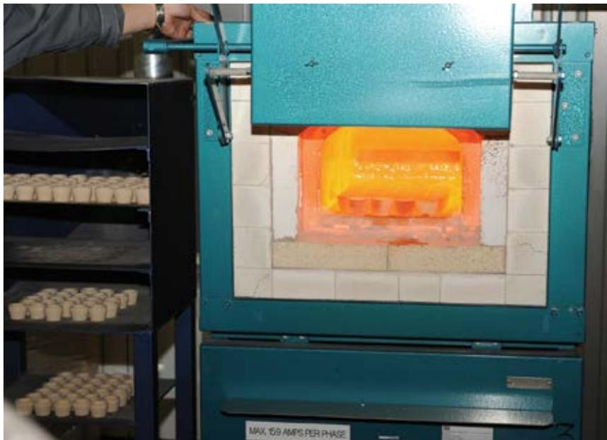
Плавильное отделение. Купелирование проб
