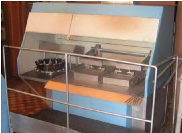
Конструкция печей «ТИТ.12» обеспечивает низкие градиенты температур как в рабочей зоне установки садки, так и по высоте плавильных тиглей и позволяет гарантировать ее стабильную тепловую работу, а секционированные подставки — четкое размещение тиглей и защиту от технологических проливов шлака.
