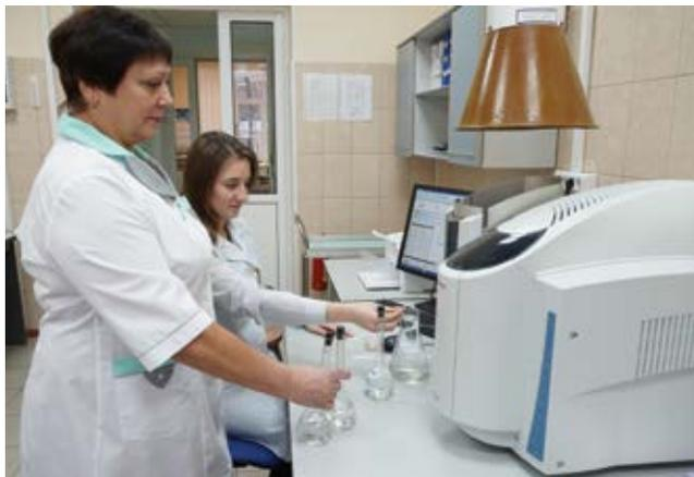
Наравне с точными методами измерений очень широкое применение находит и **полуколичественный анализ**. Для этого используют оптический эмиссионный спектральный метод определения примесных элементов (29–36 компонентов), применяемый при выполнении геологоразведочных работ, и нестандартный рентгенофлуоресцентный метод (РФА) для первичной оценки состава неизвестных или малоизученных проб.
