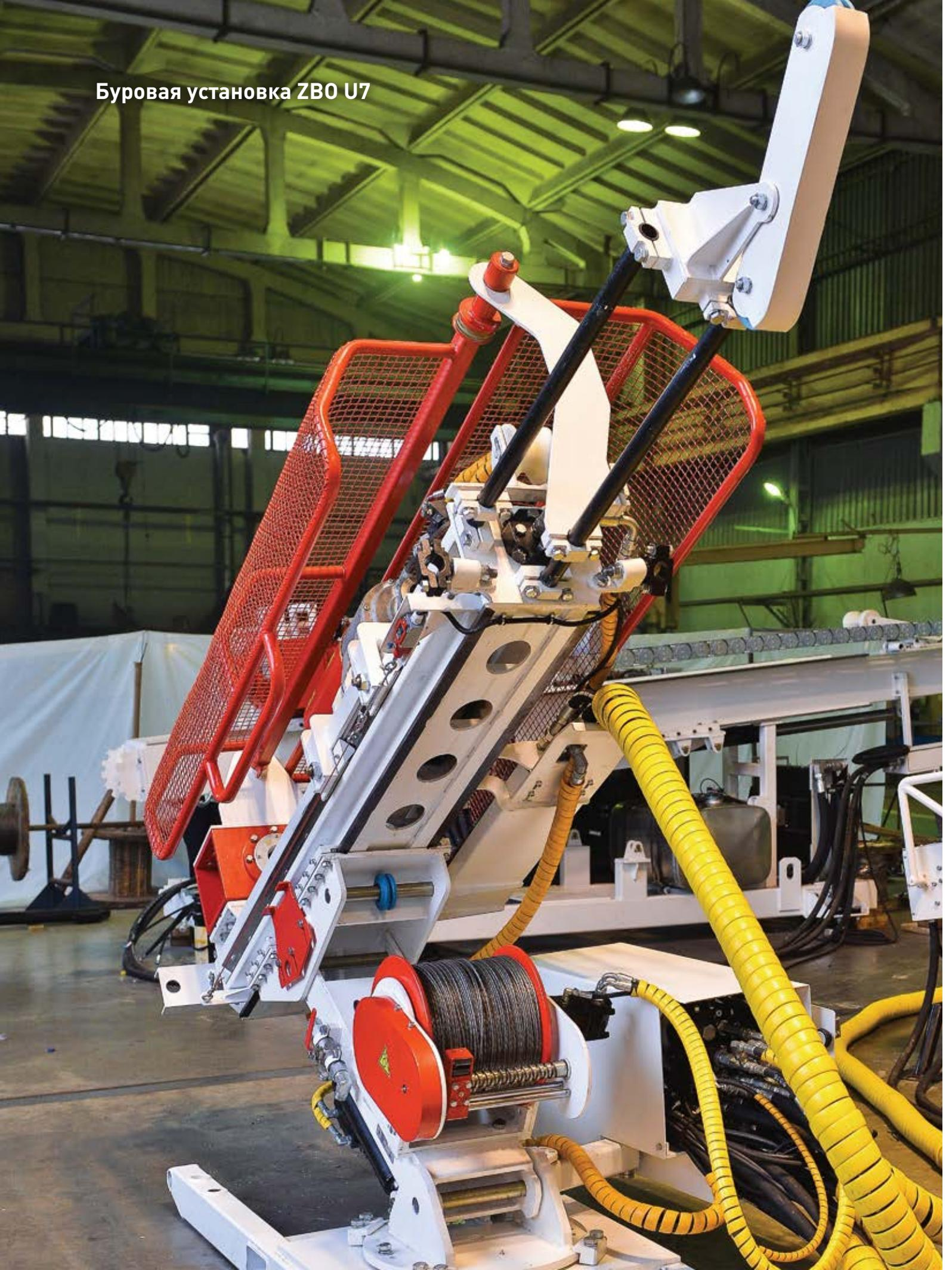
новка ZBO U7 предназначена для высокоскоростного алмазного разведочного бурения на твердые полезные ископаемые в шахтных выработках.
