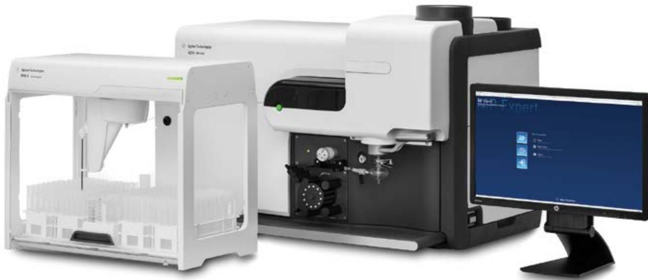
Agilent 4210 МП АЭС с автосамплером SPS 4, который позволяет выполнять многоэлементный анализ без участия оператора
