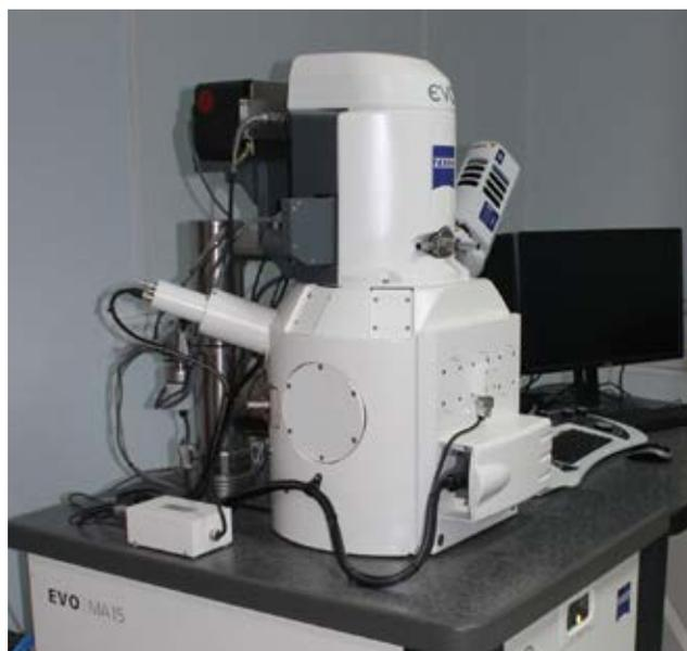
С его помощью можно изучить морфологию частиц пробы размером в несколько микрон, а также определить их химический состав, что является основой для прогнозирования качества и количества продуктов, которые могут быть получены при переработке сырья.
