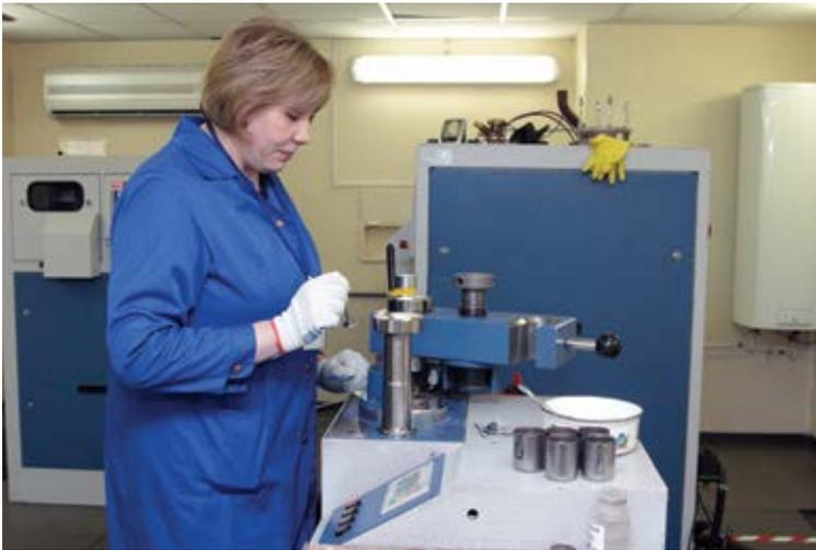
Подготовка пробы для определения элементного состава в аналитической лаборатории ЦТКиЛИ
