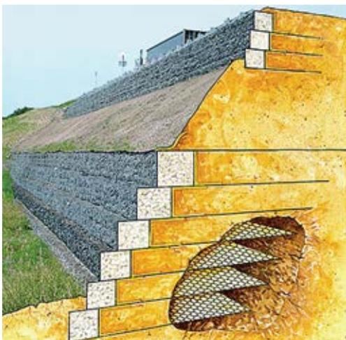
Рис. 1. Армогрунтовая система «Террамеш»
