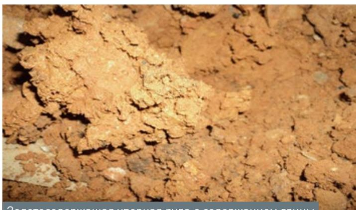
Золотосодержащая упорная руда с содержанием глины до 70 % (Восточная Сибирь) для испытания установки HAVER HYDRO-CLEAN 700
