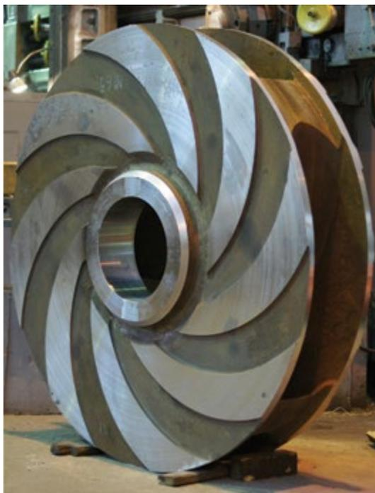
Первые шаги по выпуску данного вида техники мы начали в 2010 году. В основу агрегата лег конструктив типовых моделей 2ГрТ 8000/71. Мы сохранили базовые характеристики наиболее распространенного насоса: привязку к фундаменту, привязку к подающим трубопроводам и трубопроводам нагнетания, — это позволило исключить дорогостоящие строительные-монтажные работы. Реализованные технические решения защищены патентом РФ на ПМ № 106679. На насос получен сертификат соответствия.
