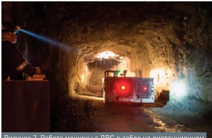
Рисунок 2. Работа машины с ДВС в забое на дистанционном радиоуправлении, джойстиком, оператором, при визуальном контроле в 45–95 м от забоя камеры
