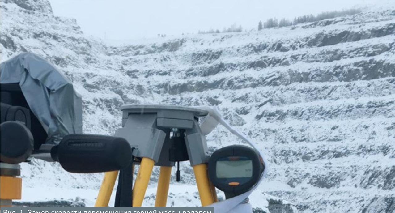
Рис. 1. Замер скорости перемещения горной массы радаром
