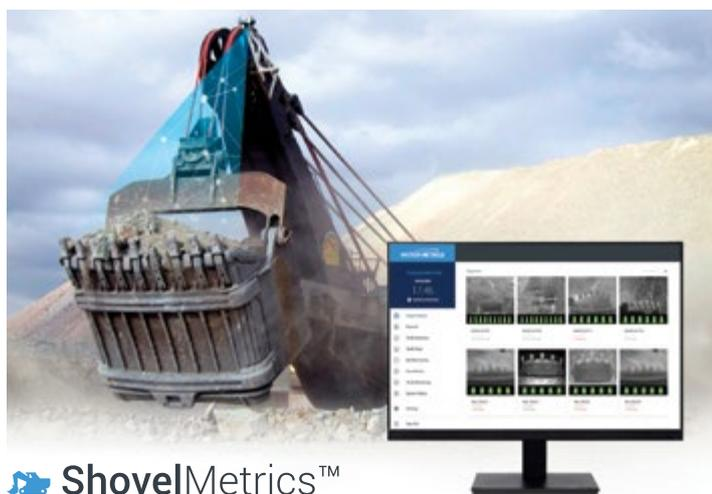
плуатации ShovelMetrics™, установленной в настоящий момент на 100 объектах добычи по всему миру. К примеру, в канадской компании «Тек Коул» система использовалась в течение двух лет для исследования фрагментации грансостава при опытным определении оптимального количества взрывчатых веществ, в результате которого была выявлена возможность сокращения их удельного расхода до 15 % без ущерба для качества работ.
