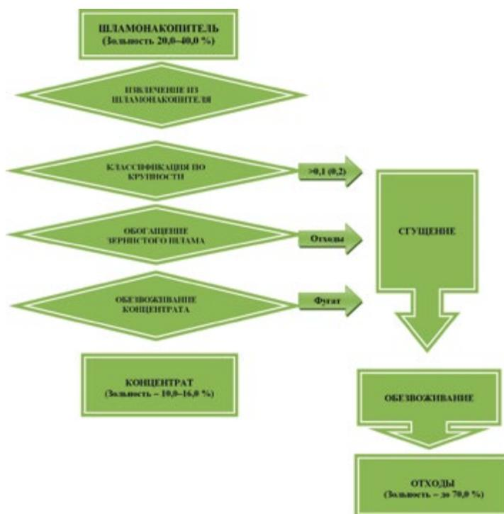
Подобная технология обогащения угольных шламов позволит выделить из шламонакопителя как минимум 30–40 % концентрата зольностью 10–16 %, который можно использовать не только в энергетических целях, но и в качестве добавки к шихте коксования, т. к. в шламонакопителе складированы отходы обогащения коксующихся углей, и одновременно решить ресурсосберегающие и экологические проблемы.
