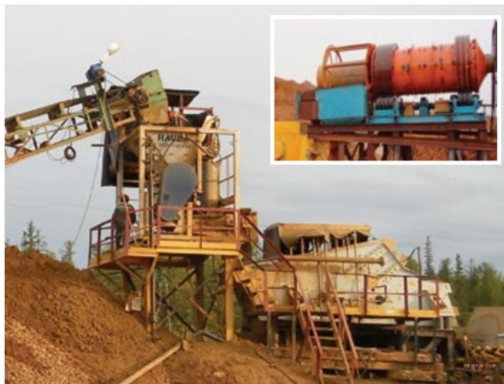
Производственные испытания HAVER HYDRO-CLEAN (HC 700) и скруббера для сравнения качества дезинтеграции и промывки золотосодержащих окисленных руд (сентябрь 2012 года) трех месторождений с содержанием тонких фракций от 30 до 70 %
