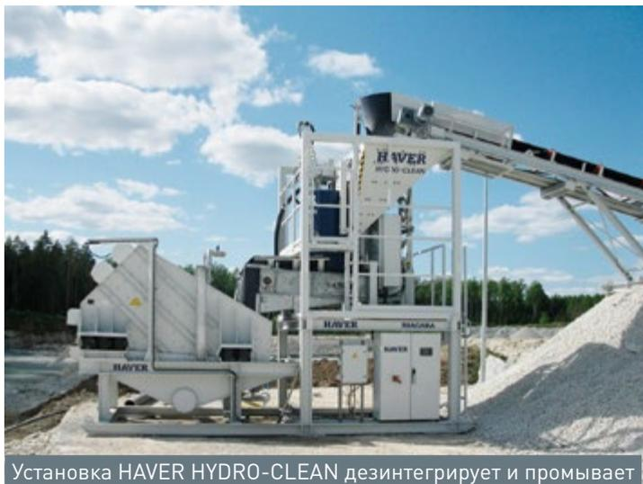
Установка HAVER HYDRO-CLEAN дезинтегрирует и промывает упорное сырье. Грохот в комплекте с установкой промывки и классификации
