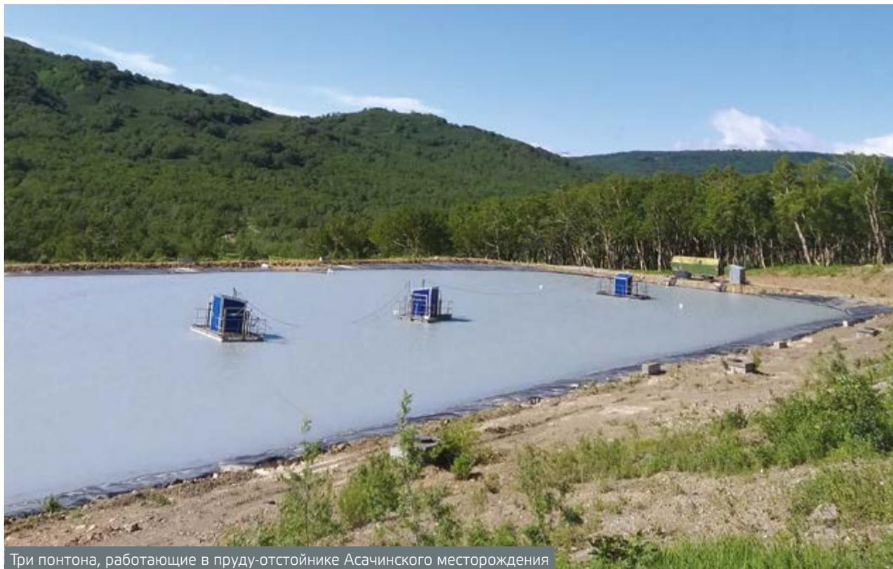
Три понтона, работающие в пруду-отстойнике Асачинского месторождения
