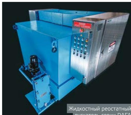
Жидкостный реостатный пускатель серии DAFA
