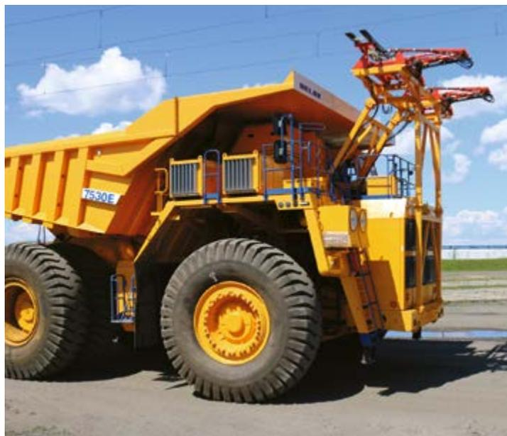
Оборудование становится активным, когда самосвал подъезжает к воздушной сети. В этот момент механизм поднимается и своей верхней частью касается провода. Напряжение от троллей через шкаф управления поступает на электродвигатели редукторов мотор-колес, и 220 т груза едут вверх. Преодолев самую высокую точку трассы, самосвал опускает пантограф и едет на спуск, но уже на дизельном двигателе.
