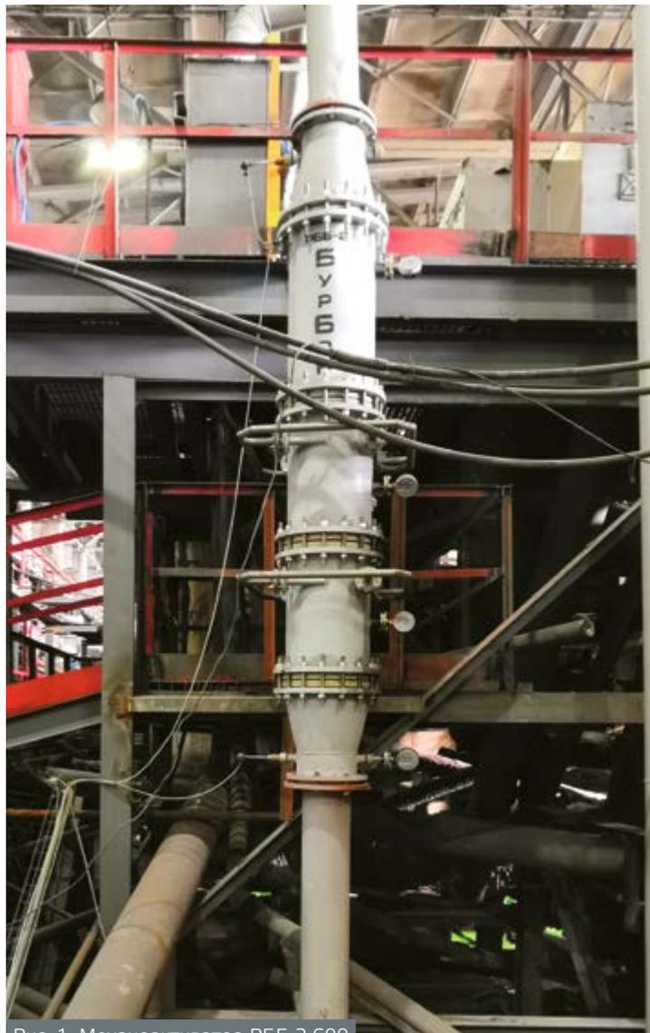
Рис. 1. Механоактиватор РББ-2-600
