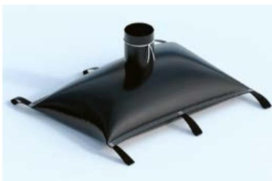
Принцип работы геотекстильного контейнера таков: загрязненная шламами вода подается непосредственно в контейнер через приемную горловину (если размер контейнера большой, таких горловин может быть несколько). Под действием сил гравитации твердая составляющая опускается вниз, а вода выходит через поры ткани. Отделение воды можно ускорить путем добавления хими-
