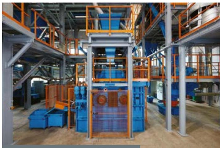
Рис. 3. Пилотная установка HPGR Kopperg (диаметр валков — 1 000 мм, ширина валков — 230 мм, установленная мощность — 250 кВт)
