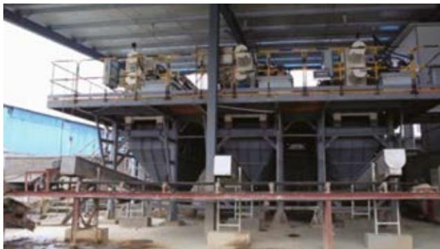
Рис. 32а, б. Фильтр-прессы JJ на проекте
