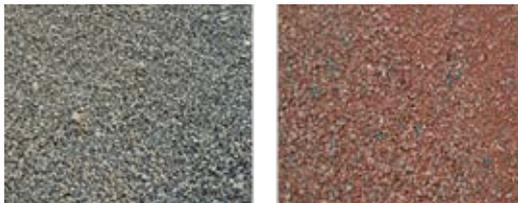
Рис. 3. Внешний вид руды до и после обжига
