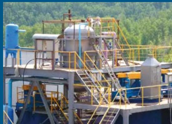
Оборудование для интенсивного окисления и выщелачивания (ТДС, «Тайфун» и механоактиваторы)
