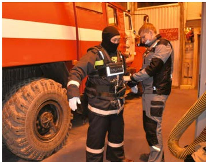
Конструкция состоит из внешнего каркаса и приводящих частей. Когда пользователь, например, поднимает руку, экзоскелет включается в действие, тем самым усиливая движение.
