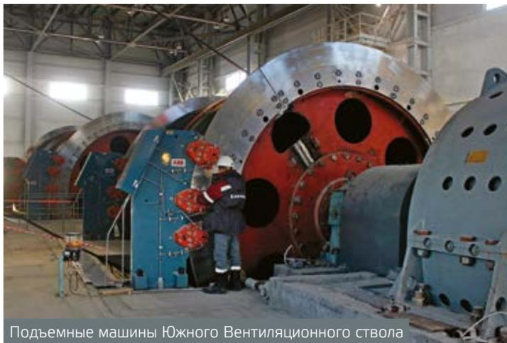
Подъемные машины Южного Вентиляционного ствола
