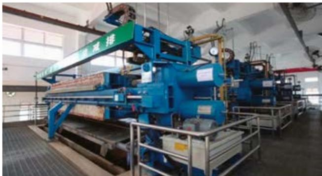
Рис. 26. Фильтр-прессы JJ на проекте
