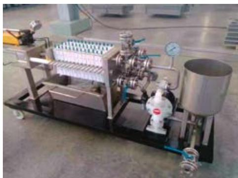
Рис. 50. Лабораторный камерно-мембранный фильтр-пресс
