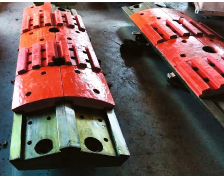
**А**льтернативные запасные и изнашиваемые части для горнорудного оборудования Element могут быть не просто аналогами оригинальных деталей, но и их улучшенными версиями. Причем улучшения касаются не только материалов изготовления. При необходимости компания предлагает создать совершенно новую геометрию частей оборудования.
