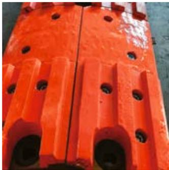
После отгрузки в июне 2021 года сервисная команда ГОКа собрала сегменты для валковой дробилки согласно разработанной Element инструкции. Производитель гарантировал наработку, равную средней ходимости оригинала — 216 тыс. т. По факту же брони наработали 288 034 т. Таким образом, прирост наработки составил 33 %.
