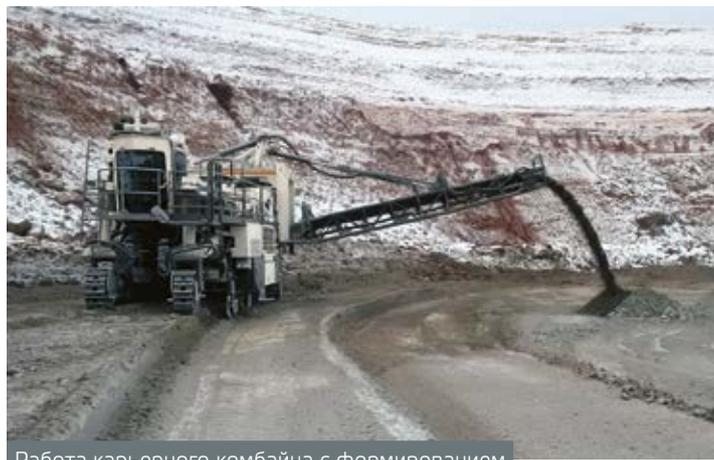
Работа карьерного комбайна с формированием штабеля разрыхленной руды
