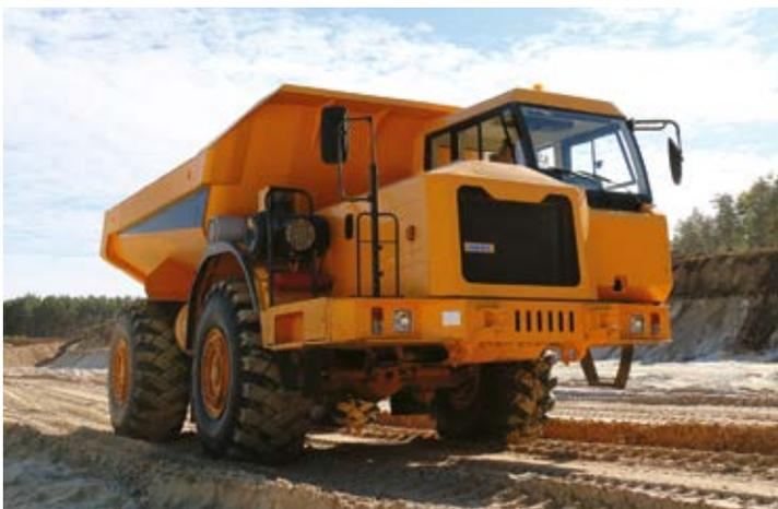
Установлена специально разработанная для этого класса машин комфортабельная кабина со встроенной системой защиты ROPS и FOPS.
