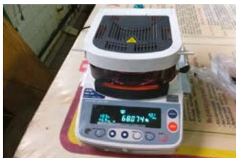
Рис. 49. Определение остаточной влажности кека
