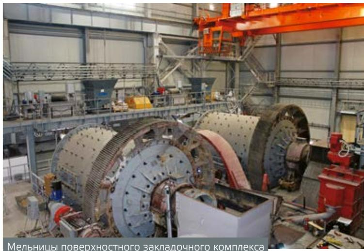
Мельницы поверхностного закладочного комплекса
