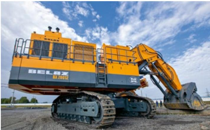
промышленности Республики Беларусь — изготовлении карьерного гидравлического экскаватора ВХ20012 массой 200 тонн с емкостью ковша 12 м<sup>3</sup>. Именно на наших производственных площадках был изготовлен первый опытный образец гусеничного хода с приводом, являющийся несущей конструкцией для блока моторного, кабины, рабочего оборудования и предназначенный для передвижения и поворота платформы данной машины.
