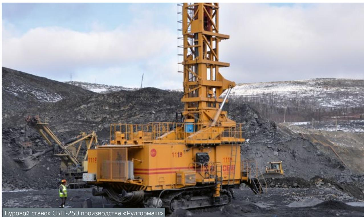
Буровой станок СБШ-250 производства «Рудгормаш»
