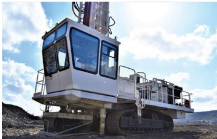
Завершены на предприятии испытания и другой отечественной новинки — экспериментальной буровой установки БС-215, изготовленной на Копейском машиностроительном заводе (Челябинская обл.). По задумке разработчиков, данный станок должен использоваться в сложных климатических и геологических условиях: кроме «Полюс Вернинского», образцы техники были направлены производителем на предприятия Урала и Кузбасса. До недавнего времени установки такого класса еще не изготавливались в России.
