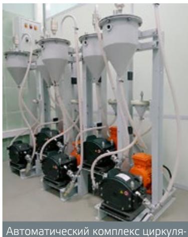
Автоматический комплекс циркуляционной пробоподдачи (АКЦП)
