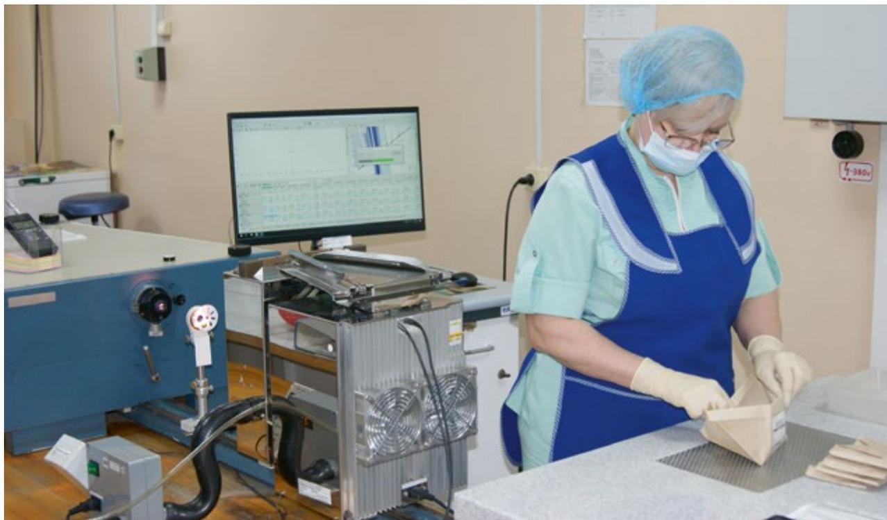
Применение анализатора МАЭС позволило автоматизировать операцию обработки спектров и сократить время проведения атомно-эмиссионного анализа. Современная система регистрации анализатора МАЭС, обладая высокой стабильностью, позволяет работать в режиме постоянного графика. Это повышает производительность и сокращает расход материала стандартных образцов. Для исключения вероятности ошибки или промаха расчет содержаний каждого элемента выполняется по нескольким аналитическим линиям.
