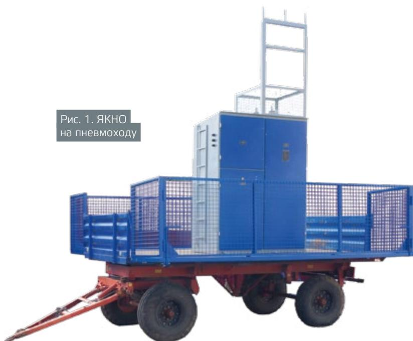
габариты: это позволило снизить воздействие вибрации при транспортировке за счет смещения точки приложения массы, а также обеспечить комфорт и безопасность персонала при обслуживании ячеек. Во-вторых, в новых ЯКНО предусмотрено применение надежного крепежа, специализированных шайб, чтобы предотвратить ослабление элементов при перевозке.
