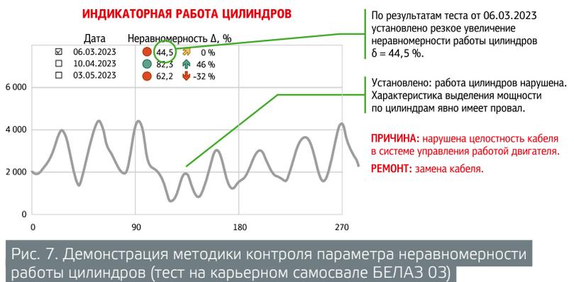
Рис. 7. Демонстрация методики контроля параметра неравномерности работы цилиндров (тест на карьерном самосвале БЕЛАЗ 03)
