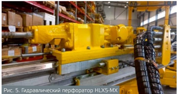
Рис. 5. Гидравлический перфоратор HLX5-MX на буровой установке DF-B1
