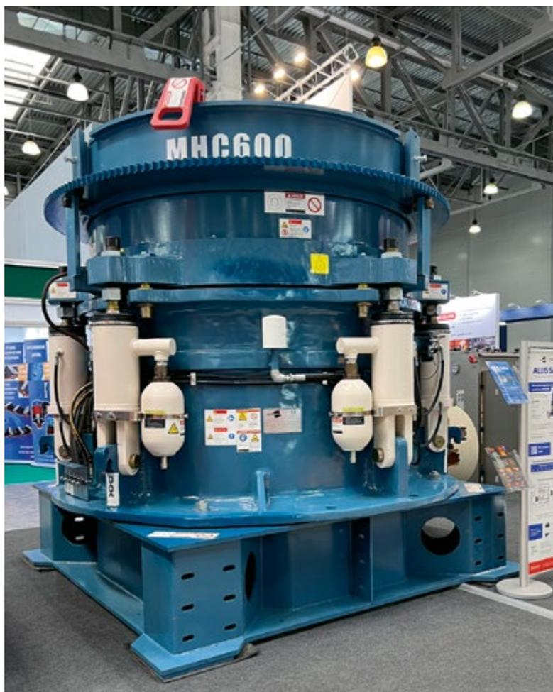
производительность и высокий коэффициент дробления. Высокая эффективность дробления обеспечивается за счет размера верхней части подвижного конуса и большого угла отклонения.
