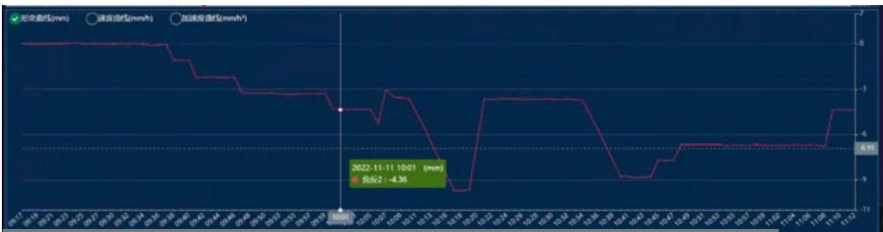
Рис. 6. График результатов измерений — отклонения фактически измеренного смещения от моделируемого
