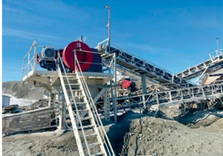
с помощью гидроцилиндра. А обеспечение постоянной высокой производительности достигается благодаря системе автоматического регулирования, позволяющей контролировать фактические показатели работы в ходе дробления.
