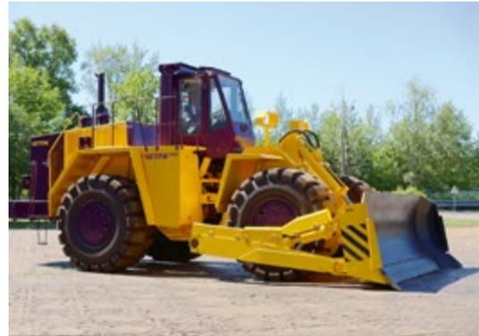
на имеет высокую производительность. Применяется для работы на угольных складах, планировки поверхностей отвалов, площадок под экскаваторы и буровые станки, строительных площадок, рытья траншей и зачистки забоев на предприятиях горнодобывающей промышленности, а также в качестве тягача при транспортировке тяжелых грузов. Кстати, колесный бульдозер и другую технику ЧЕТРА можно приобрести по государственной программе субсидирования лизинга со скидкой до 15 %.
