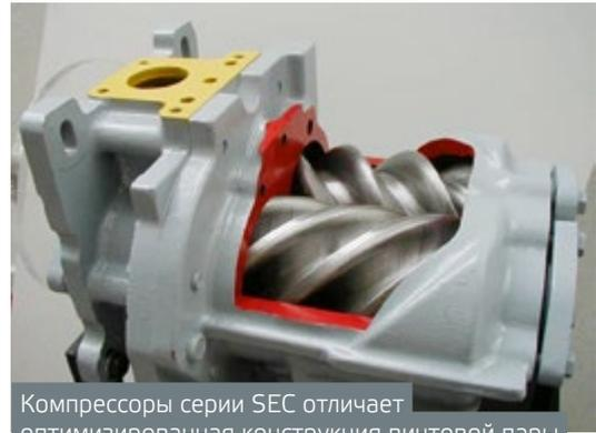
Компрессоры серии SEC отличает оптимизированная конструкция винтовой пары
