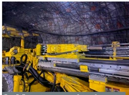
Рис. 8. Ввод в эксплуатацию буровой установки DF-B1 с гидравлическим перфоратором HLX5-MX в АО «ЕВРАЗ ЗСМК», Казская шахта
