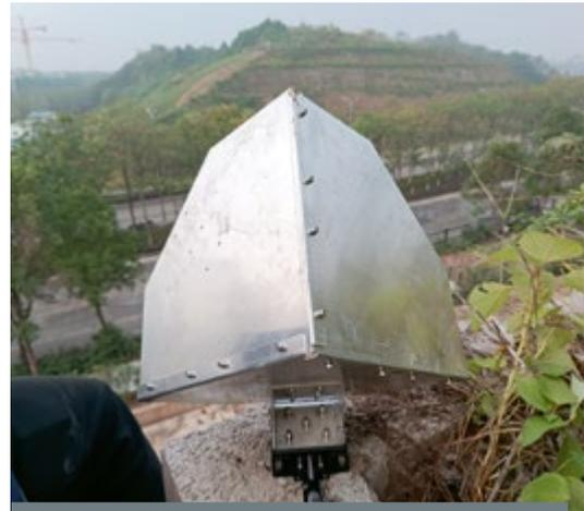
Рис. 4. Сдвижной стол с угловым отражателем и микрометром
