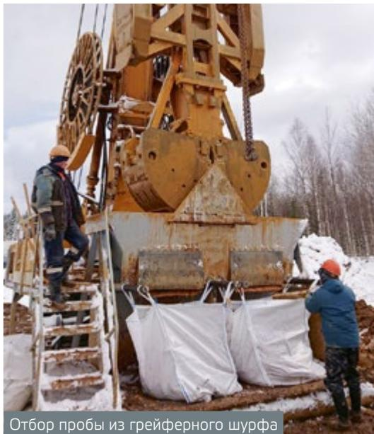
Отбор пробы из грейферного шурфа
