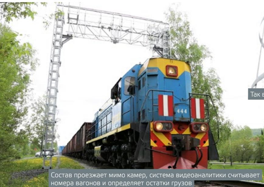
Состав проезжает мимо камер, система видеоаналитики считывает номера вагонов и определяет остатки грузов
