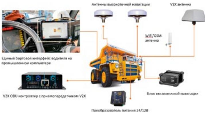
Рис. 2. Функциональная схема системы, обеспечивающей безопасность карьерного транспорта
