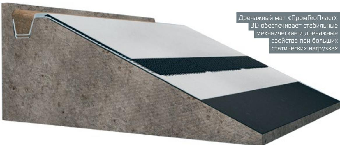
Дренажный мат «ПромГеоПласт» 3D обеспечивает стабильные механические и дренажные свойства при больших статических нагрузках
