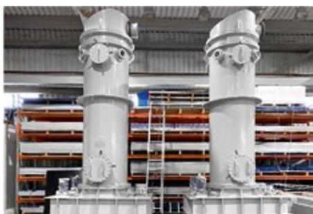
Установки очистки от агрессивных газов
