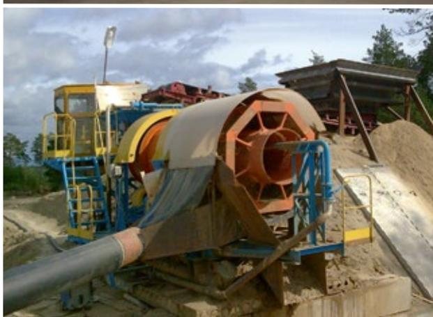
Дробильно-измельчительное оборудование (дробилка-грохот барабанного типа ДГБ)
