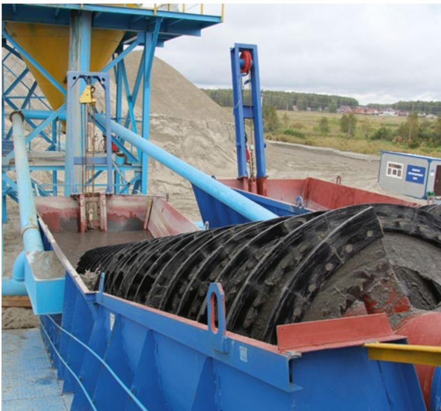
Оборудование для классификации сыпучих материалов по крупности (классификатор гидравлический многокамерный, конусный, спиральный)
