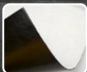
**С сигнальным слоем — ГММ Signal.** Гладкая геомембрана покрытая с одной или двух сторон цветным слоем (чаще всего белым или желтым) для более простого контроля целостности материала. Если в процессе монтажа или эксплуатации образуется повреждение, то оно сразу будет заметно за счет контраста цветов.
