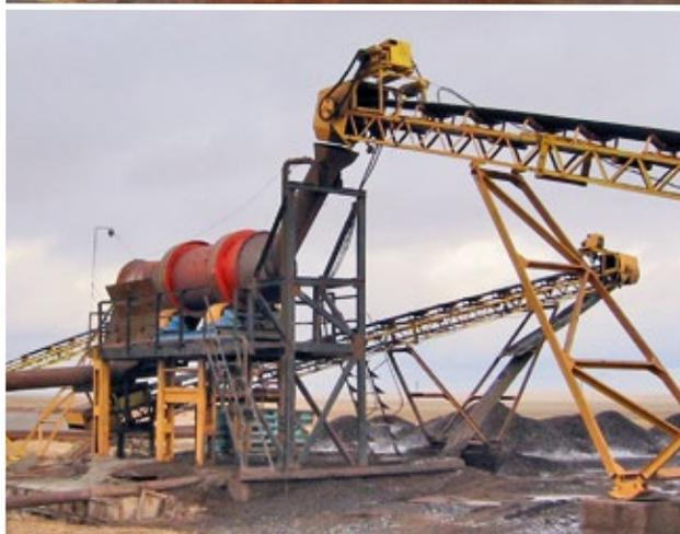
Оборудование для промывки полезных ископаемых (скруббер, скруббер-бутара)
