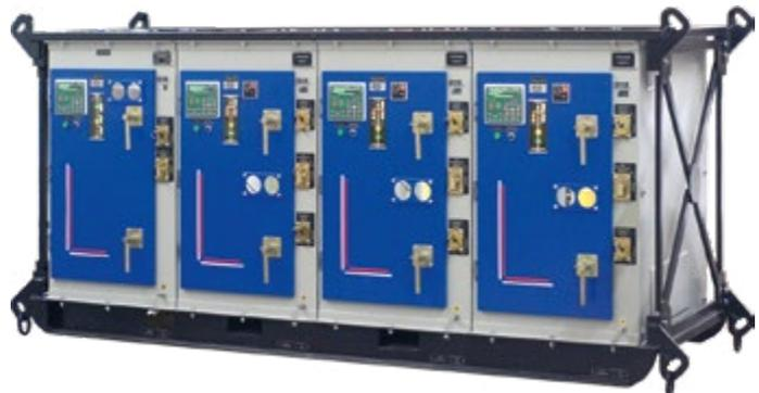
Главной целью данной разработки стало обеспечение мобильности и уменьшение размеров оборудования. Мобильность изделия обеспечивается за счёт малой массы, составляющей всего 1,5 тонны, а наличие салазок позволяет оперативно перемещать устройство по горным выработкам. Размеры одной подстанции КРУ-РН-ММ в среднем на 25–30 % меньше, чем у подстанции с КРУ-РН стандартного исполнения. Суммарно, в комплектации с одной вводной ячейкой и тремя отходящими, габариты устройства составляют 3300x1490x1120 мм.
