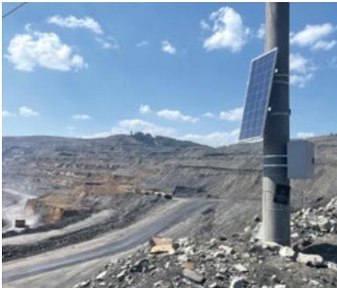
С 2023 года в «Новой Горной УК» (АО «Междуречье» и АО «УК Южная») внедрена система сейсмоконтроля SIBGEO-AM, разработанная ООО «СИГИ»; в этом году в условиях ООО «Участок Коксовый» завершается внедрение. В составе МФСБ, внедряемой на угольных разрезах, система SIBGEO-AM представляет собой сеть сейсмостанций, установленных по периметру карьерной выемки. С их помощью
