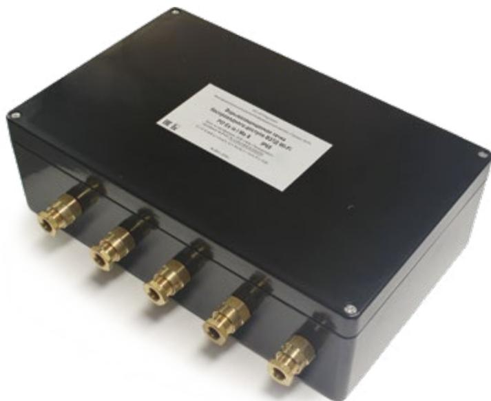
Точка доступа имеет четыре порта подключения: один порт 100/1000BASE-X (SFP ВОЛС), один порт 1000BASE-X (SFP ВОЛС) и два порта 10/100/1000BASE-T (RJ-45), из которых один порт реализован с поддержкой PoE+ (IEEE 802.3at-2009). Во взрывоопасных зонах (0) и (I) соединения между точками доступа осуществляются по ВОЛС с помощью портов SFP, а в невзрывоопасных зонах подключение совместимых устройств возможно организовать по интерфейсу PoE+ медной витой парой.
