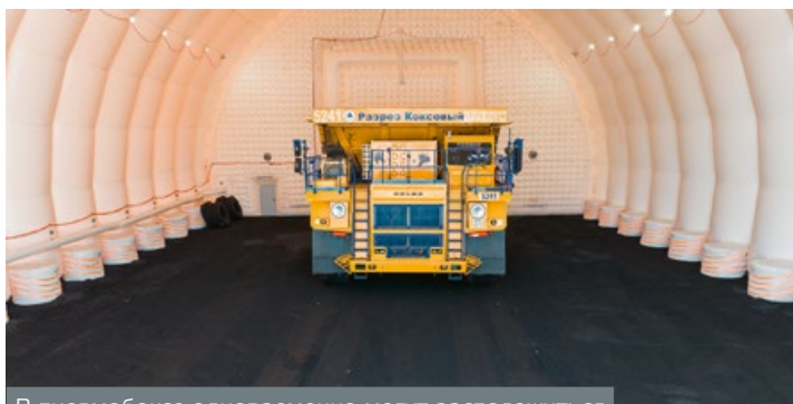
В пневмобоксе одновременно могут располагаться два 130-тонных самосвала
