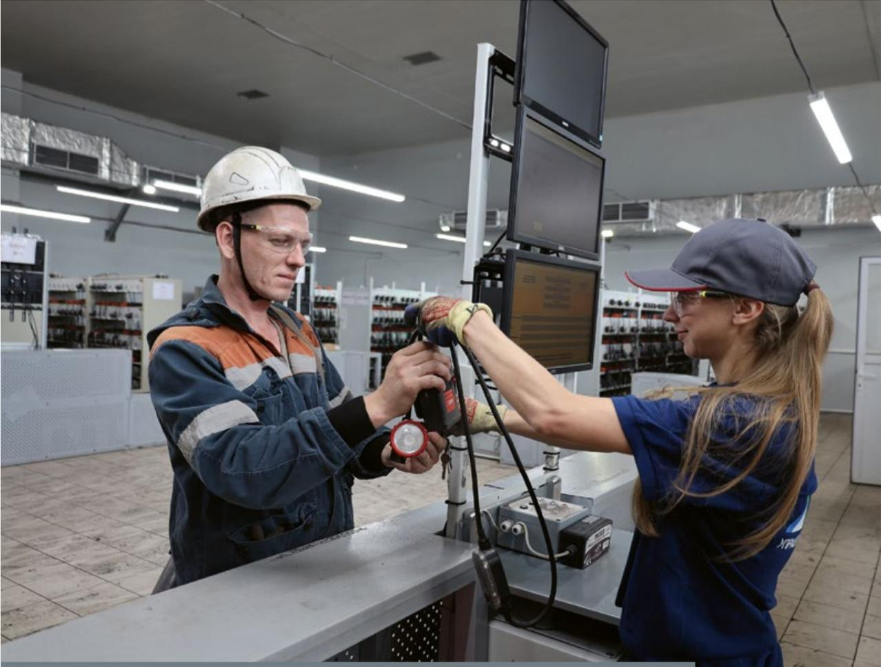
В ламповой шахтёры получают индивидуальные светильники, самоспасатели и газоанализаторы
