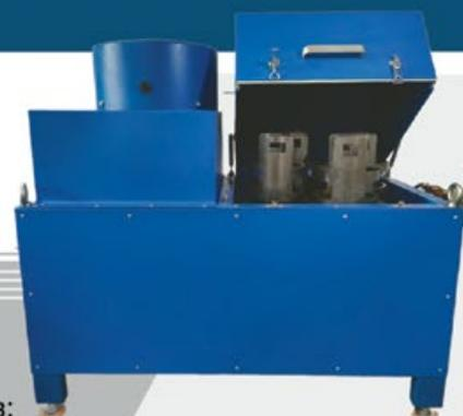
Быстрое тонкое измельчение для пробоподготовки, до 8 кг пробы за один цикл.
