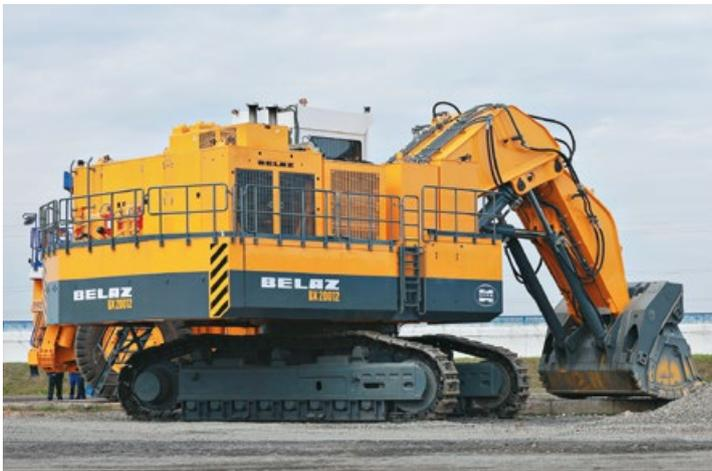
Опытный образец карьерного экскаватора BELAZ ВХ20012 класса 200 тонн оснащён 12-кубовым ковшом типа «прямая лопата» и спроектирован с учётом современного инженерного подхода. Своим функционалом, надёжной конструкцией, эксплуатационными характеристиками и высокой степенью безопасности он соответствует лучшим мировым аналогам.
