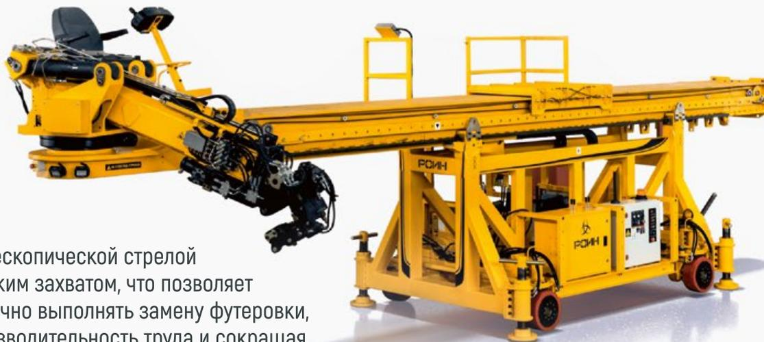
Оснащена телескопической стрелой и гидравлическим захватом, что позволяет безопасно и точно выполнять замену футеровки, повышая производительность труда и сокращая время простоя оборудования в ремонте.
