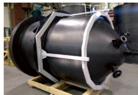
Колонны (ёмкости) кислотной обработки активированного угля
