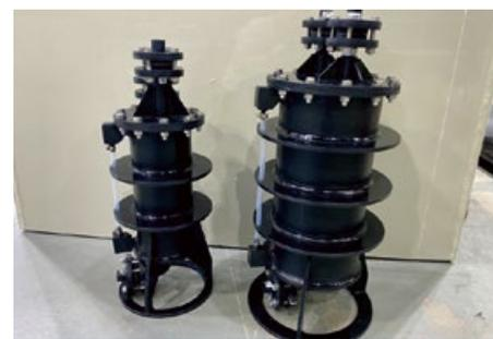
Химически стойкие вакуумные ресиверы и ловушки
