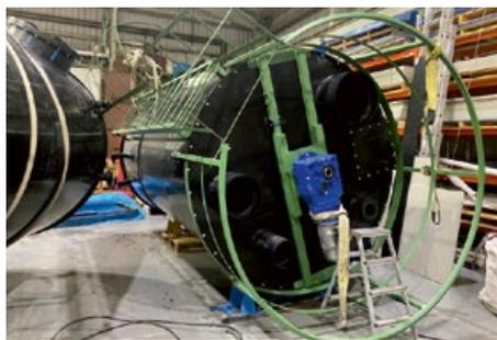
Химически стойкие реакторы и аппараты с мешалками
