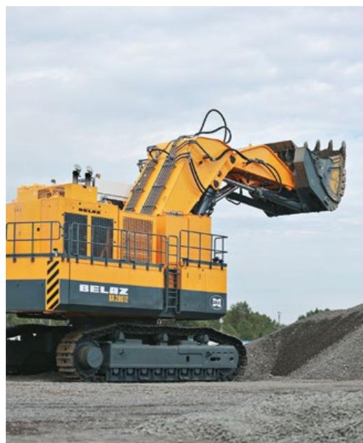
При этом машина способна перемещаться с максимальной скоростью 2,8 км/ч и преодолевать уклоны до 65%. В технике применены многодисковые маслом охлаждаемые тормоза (ММОТ) с пружинным включением и гидравлическим отключением.
