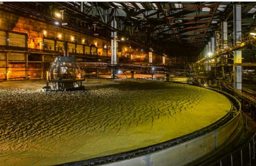
оценивает система компьютерного зрения — простой контактный датчик не выдержал бы работы в агрессивной среде.
