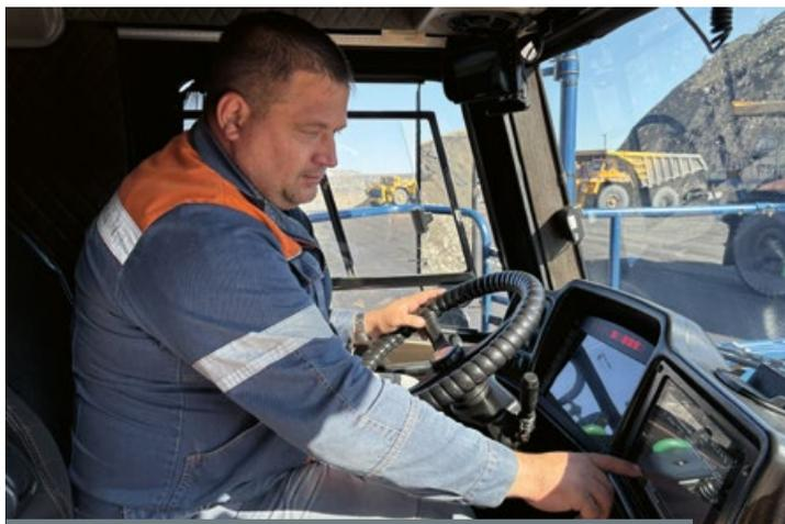
На цифровом планшете в кабине водитель видит основные параметры технологического процесса и работы автосамосвала
