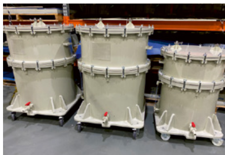
Химически стойкие нутч-фильтры из полипропилена РРН
