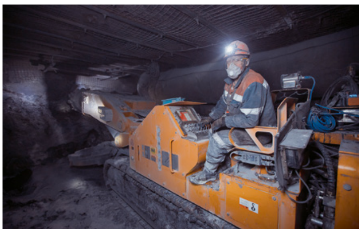
Проходческие комбайны шахт Новой Горной УК оснащены системой «Свой-чужой» для блокировки техники при попадании человека в опасную зону
