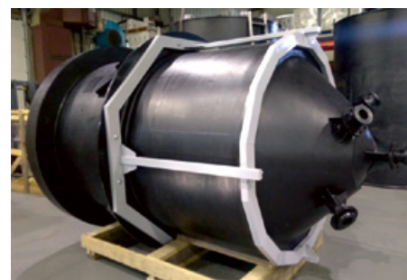
Колонны (ёмкости) кислотной обработки активированного угля
