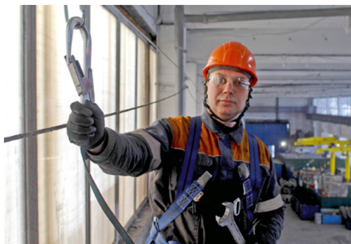
Анкерные линии в цехе ремонтно-механических мастерских разреза «Междуречье» страхуют работников при обслуживании подкрановых путей
